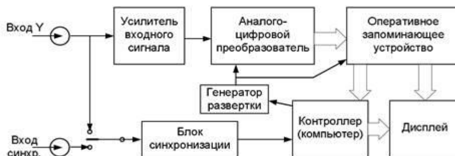
Рис. 3.9. Упрощенная структурная схема цифрового осциллографа
