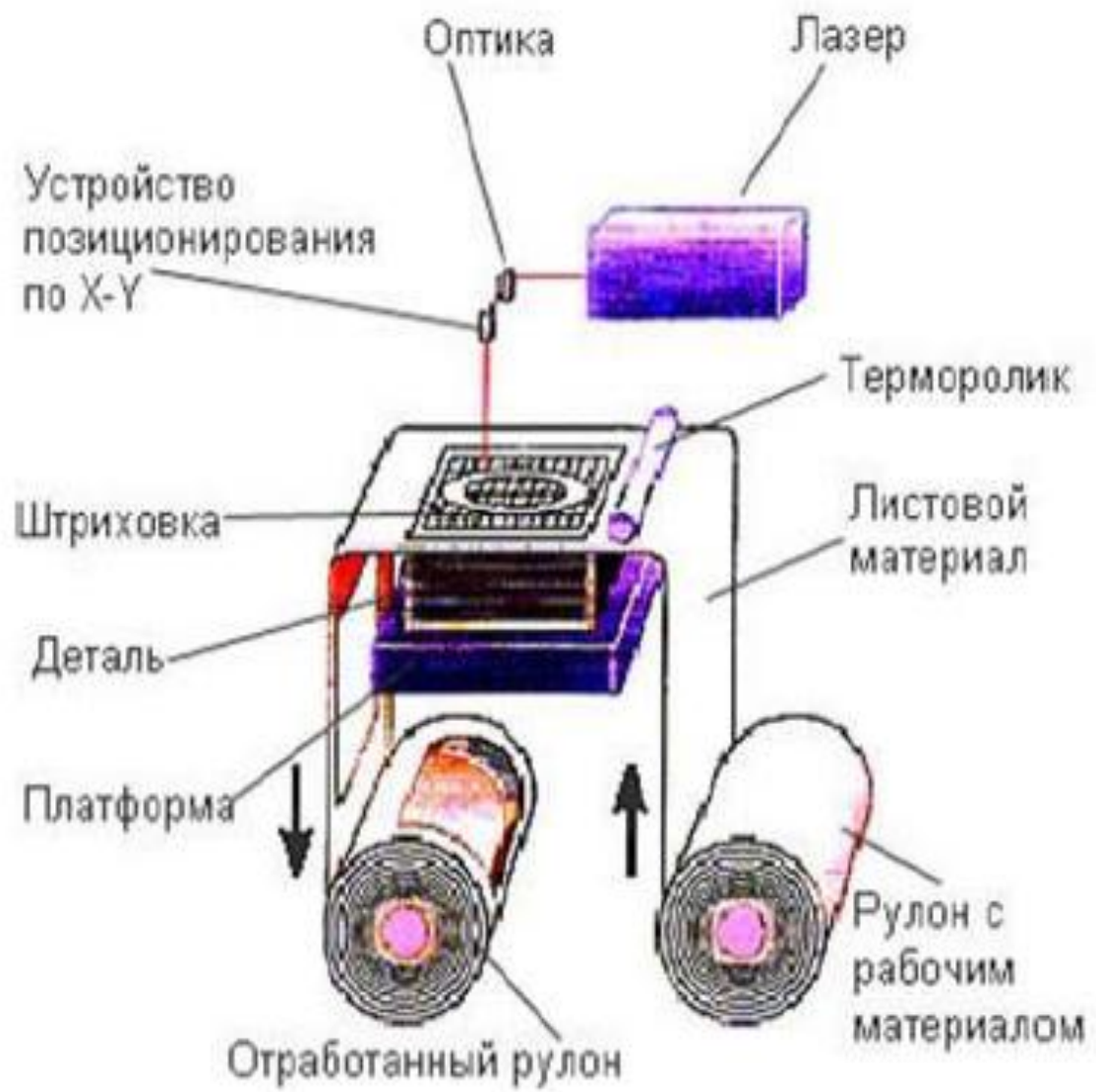
Схема создания прототипа по LOM – технологии
