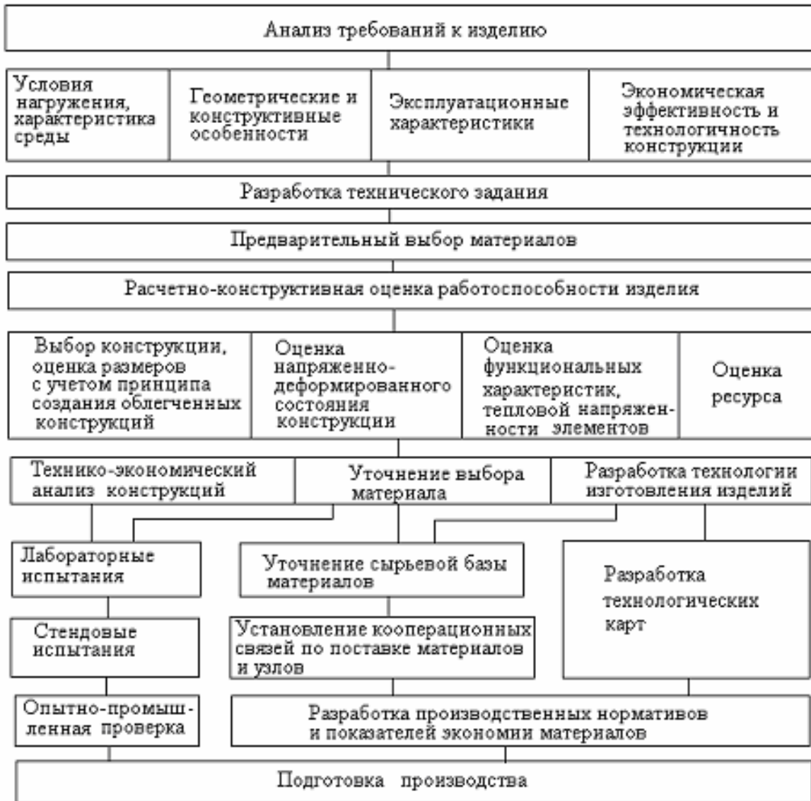
Рис. 8.1. Схема выбора материала или требований к новому материалу
