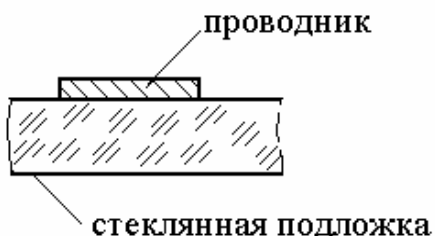
Рис. 4.7. Применение стеклянных подложек для тонкопленочных микросхем
