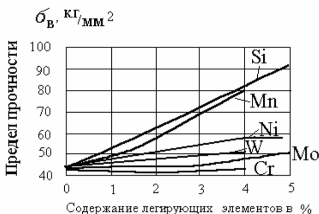
Рис. 3.1. Зависимость \sigma_v стали от содержания легирующих элементов феррите
