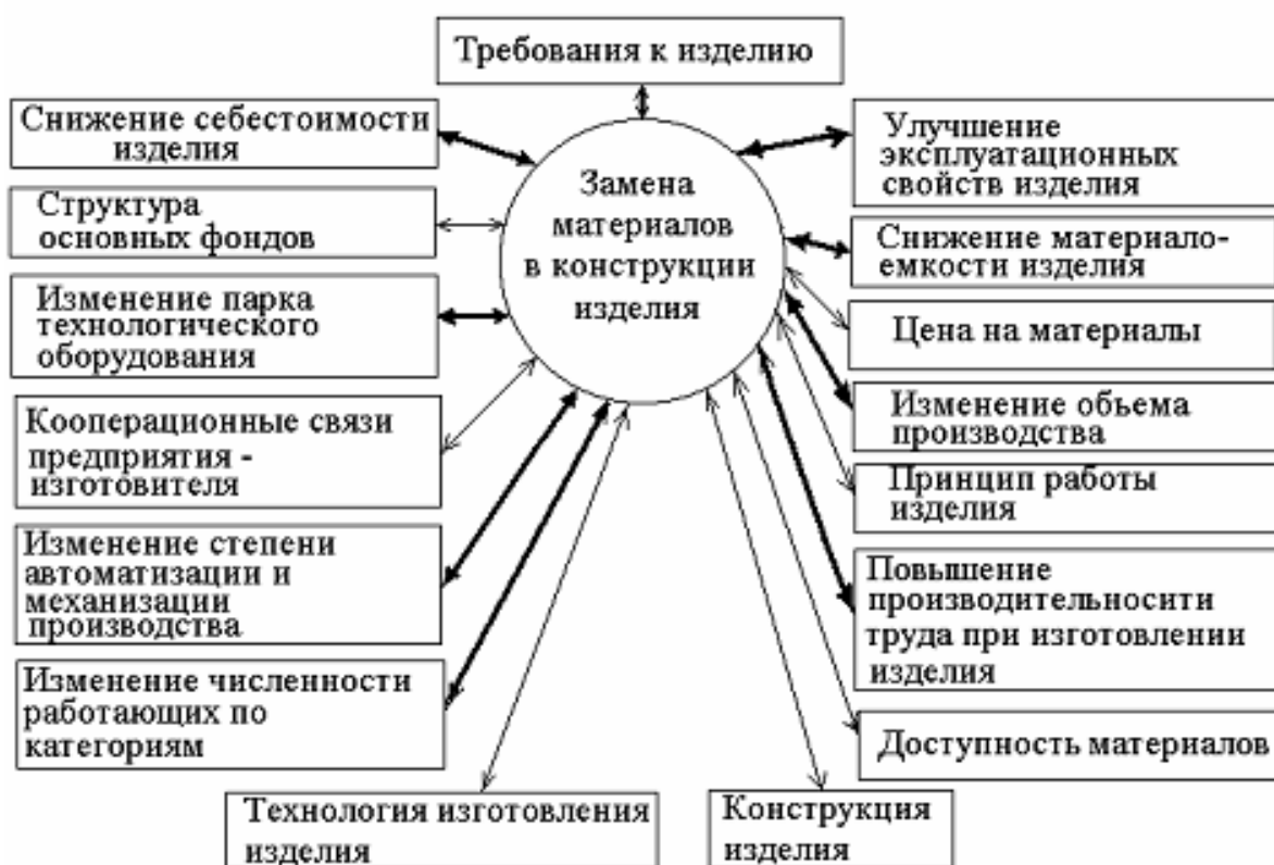
Рис. 8.2. Совокупность факторов, обуславливающих целесообразность замены материалов при изготовлении (жирные стрелки - прямое влияние, тонкие – косвенное)
