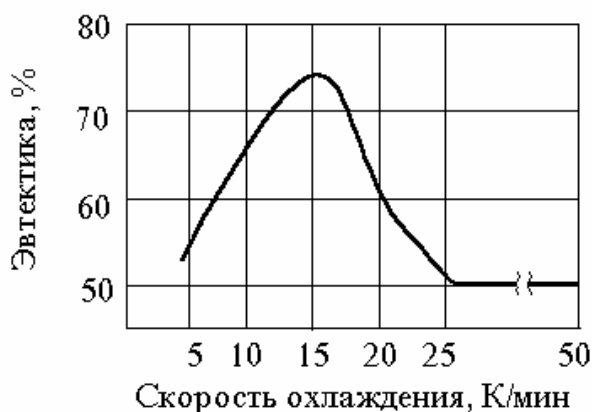
Рис. 15.13 Зависимость эвтектической составляющей в структуре шва от скорости охлаждения шва
