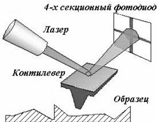
Рис. 16.19. Схема регистрации отклонения лазерного луча от начального откалиброванного положения
