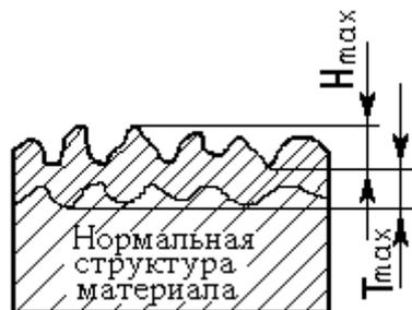
Рис. 1. 2. Схема поверхностного слоя:
