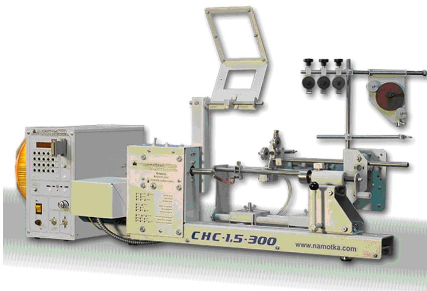
Рис. 12. Станок для рядовой открытой намотки катушки
