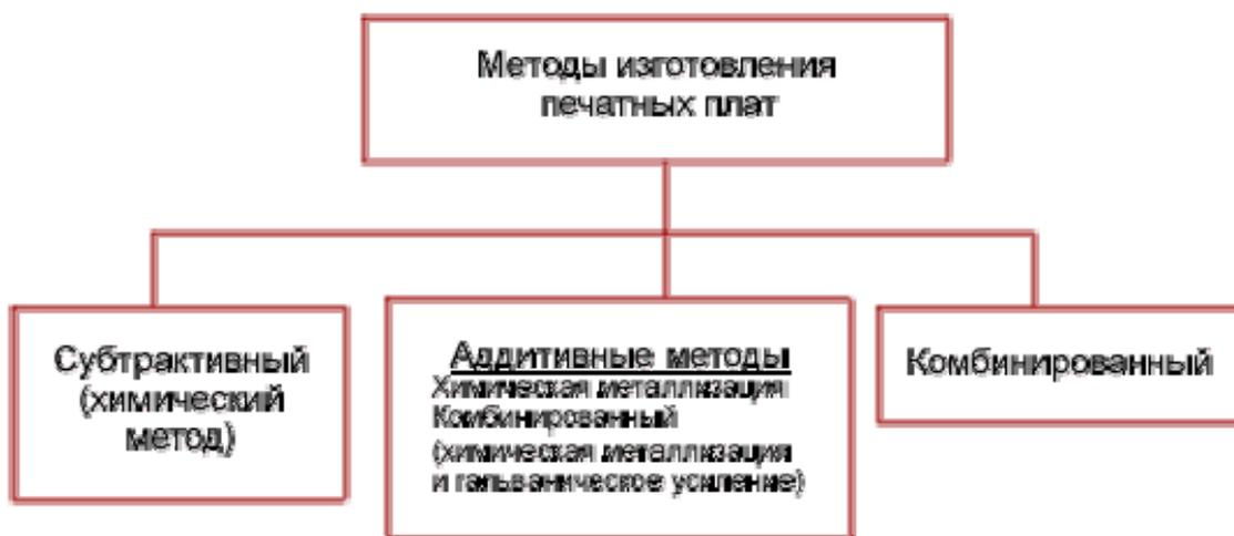
Рис. 2.5. Классификация методов изготовления печатных плат
