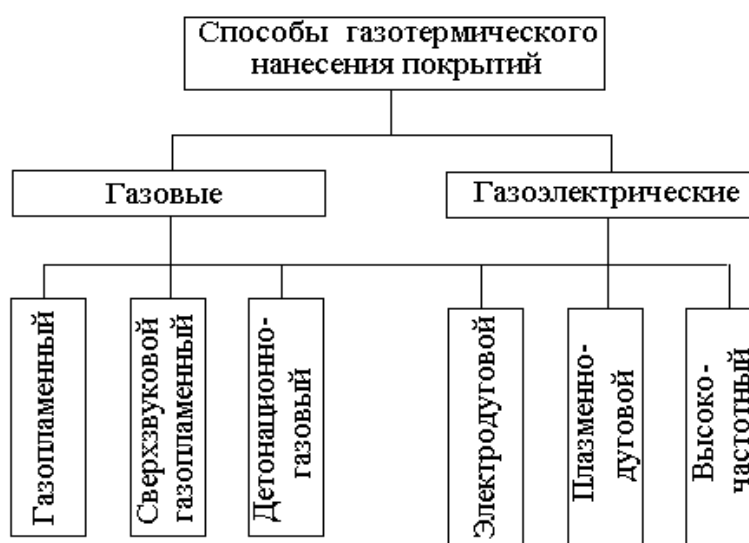
Рис. 3.2. Классификация процессов газотермического напыления покрытий по энергетическому признаку
