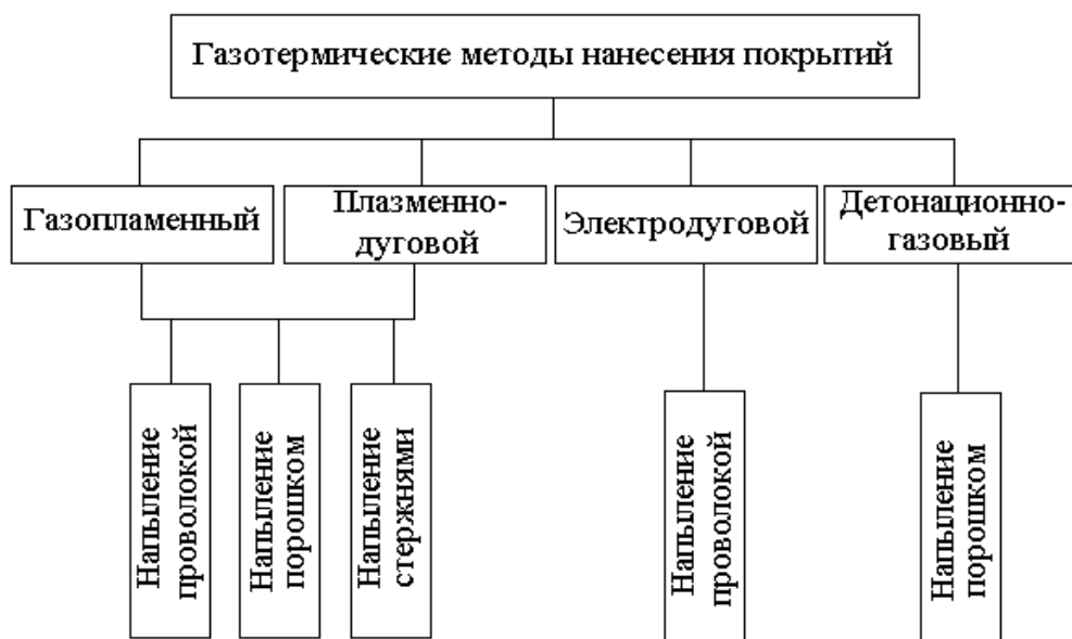
Рис. 3.3. Классификация способов газотермического напыления по форме напыляемого материала
