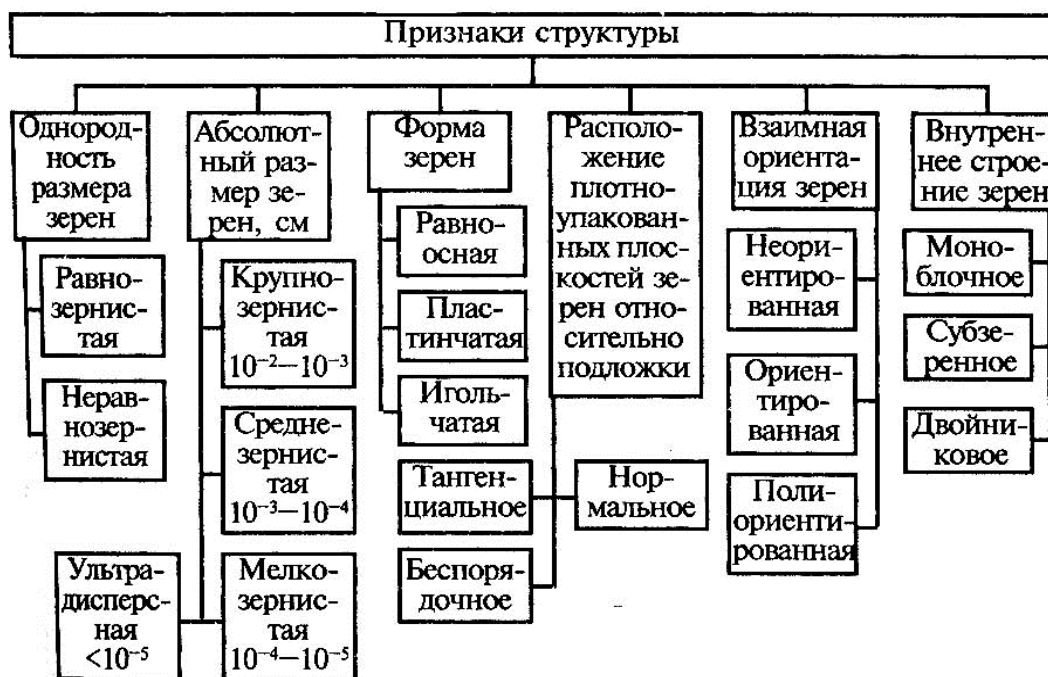
Рис. 4.3. Варианты зеренной структуры электролитических покрытий
