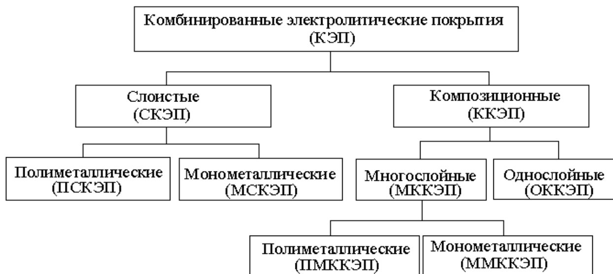
Рис. 4.4. Классификация КЭП по характеру формируемой структуры осадка
