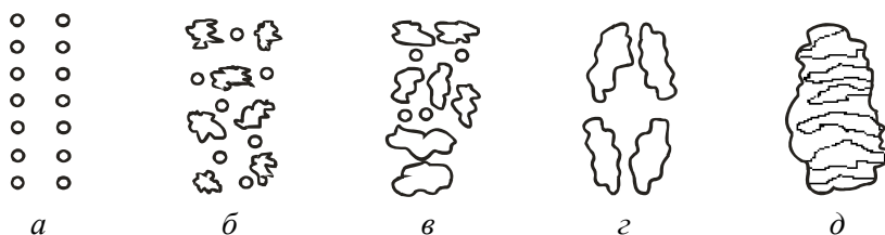
Рис. 5.3. Стадии образования конденсированной пленки при ионном распылении
