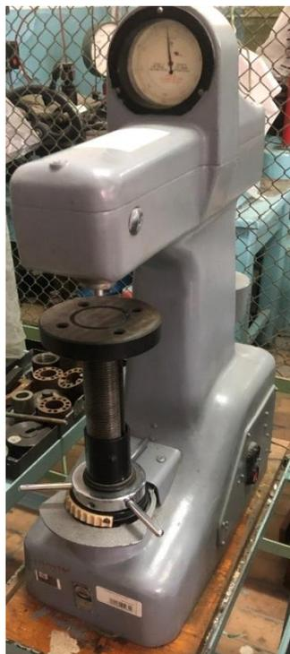
Рисунок 7 – Твердомер ТК- "М N1916.
