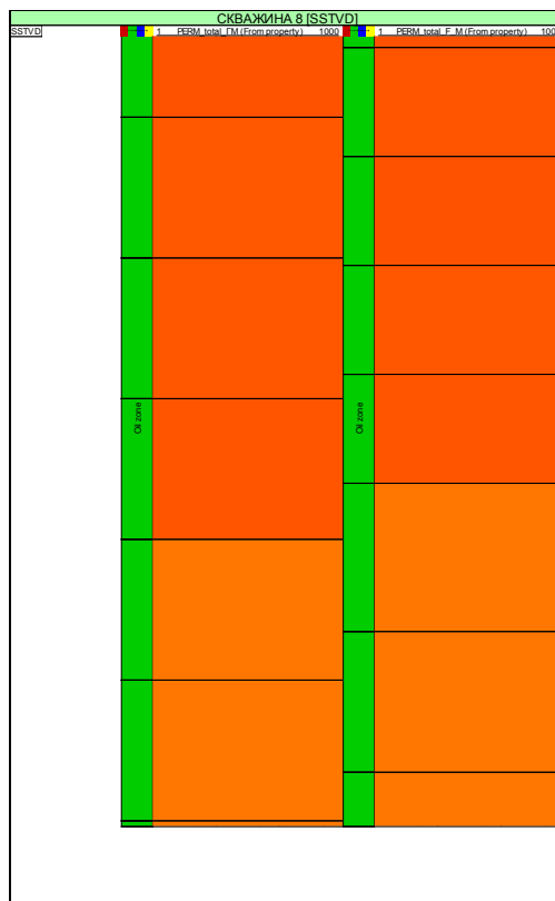
Рис. 6.6. Сравнение общей проницаемости геологической (слева) и гидродинамической (справа) моделей в скважине 8
