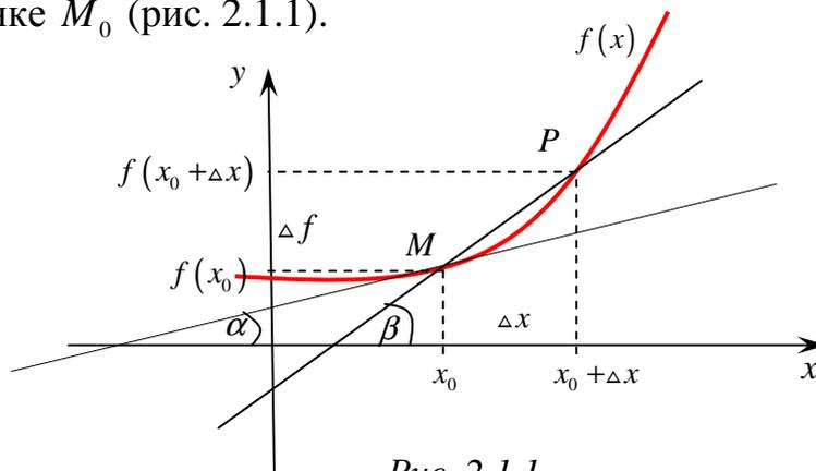
**Геометрически** производная  $y'$  функции  $y = f(x)$  представляет угловой коэффициент касательной к графику этой функции:  $y' = \operatorname{tg} \alpha$ .
