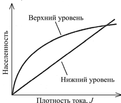
Рис. 2. Схематические зависимости населенностей верхнего и нижнего уровней He-Ne лазера от плотности тока разряда
