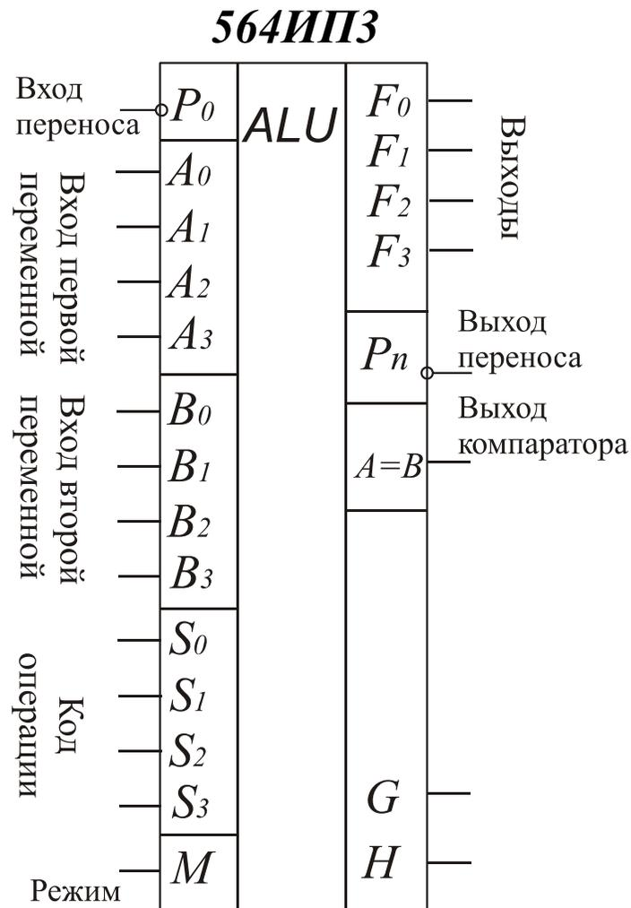
Тип выполняемой операции (логическая или арифметическая) определяется уровнем управляющего сигнала на входе  $M$  (mode control). Если  $M=1$ , то в схеме блокируются все внутренние переносы и она поразрядно выполняет логические операции. При  $M=0$  разблокируются внутренние переносы и ИС выполняет арифметические операции.
