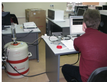
Рисунок 4.5.14. Вид коаксиального HpGe детектора в криостате
