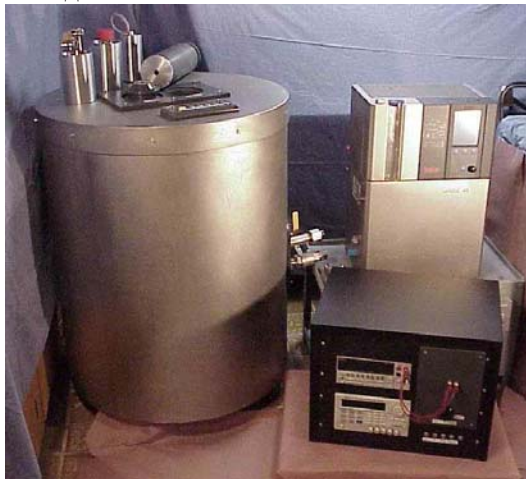
Рис. 4.8.9. Внешний вид 18-ти дюймового дифференциального калориметра широкого спектра применения
