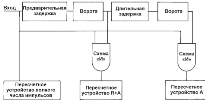
Рис. 4.8.7. Схема совпадений с продлеваемым мертвым временем на двух одновибраторах равной длительности
