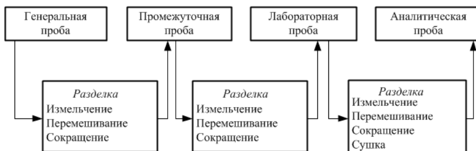
Рис. 4.7.1. Схема разделки проб и подготовки аналитической пробы
