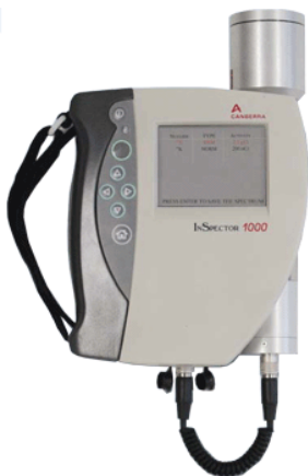
Рис. 4.2.19. Внешний вид и технические характеристики InSpector 1000 с детектором NaI(Tl) размером 2×2 дюйма
