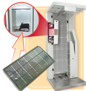
Рис. 4.2.10. Система мониторинга поверхностного загрязнения одежды и тела (LFP-180 - Low Flow Gas Proportional Detector) на основе пропорциональных счетчиков бета- и альфа-излучения
