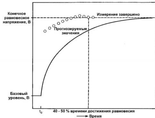
Рис. 4.8.17. Графическое представление метода прогнозирования конечной точки
