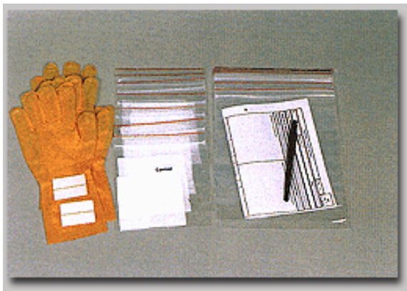
Рис. 4.7.12. Стандартный набор инспектора МАГАТЭ для мазковых проб
