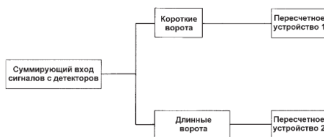
Рис. 4.8.5. Схема с переменным мертвым временем
