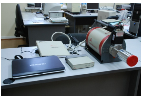
Рисунок 4.5.13. Внешний вид LeGe детектора с многоканальным анализатором
