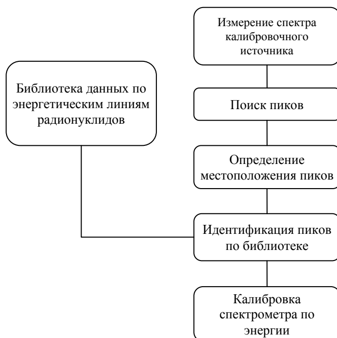
Рис. л.р.4.14. Схема выполнения процедуры калибровки \gamma -спектрометрического тракта по энергии
