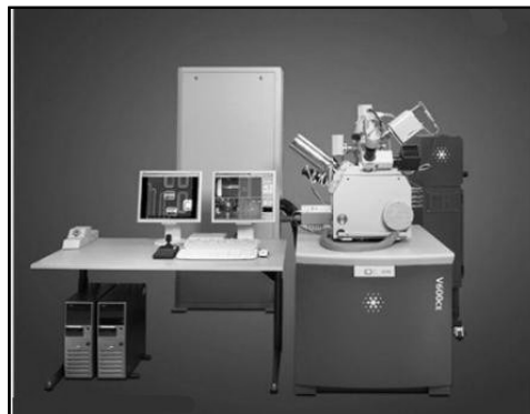
Рис. 4.7.13. Рабочее место оператора установки растровой электронной микроскопии с возможностью рентгеноспектрального микроанализа
