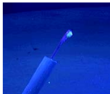
Рис. 4.7.3 Свечение в темноте под действием ультрафиолетового света кристаллофосфора (сплава урановой соли с фторидом натрия).
