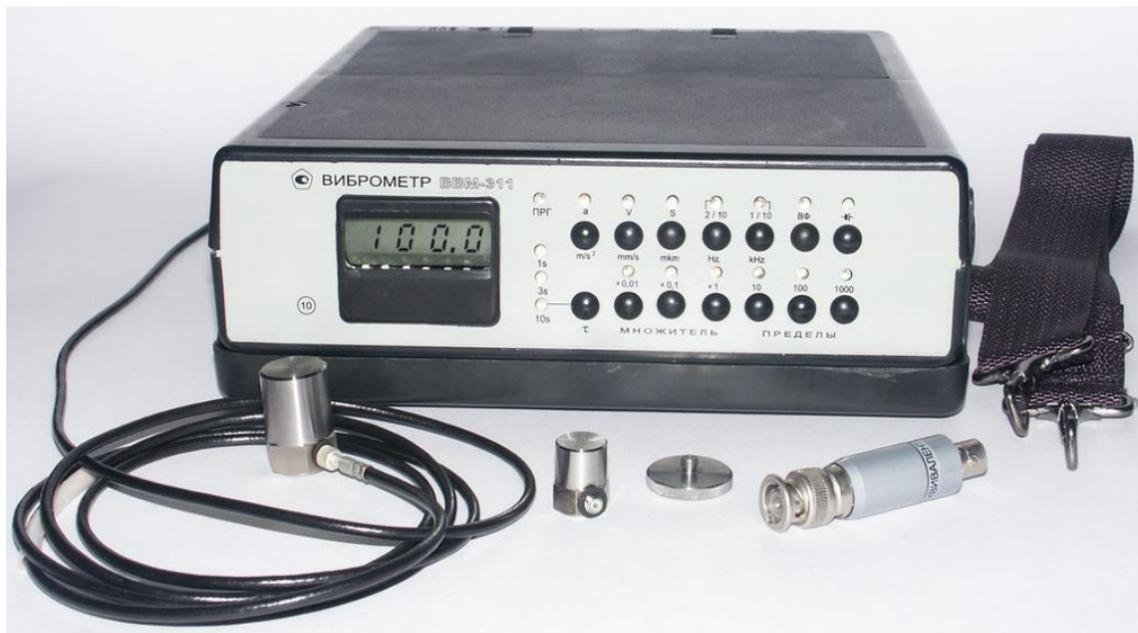
Рис. Виброметр ВВМ-311
