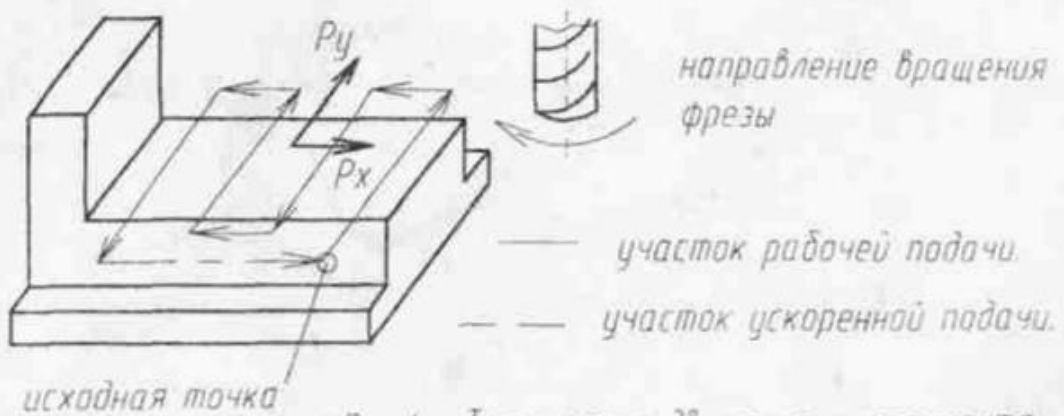
Рис.4 Траектория движения инструмента.
