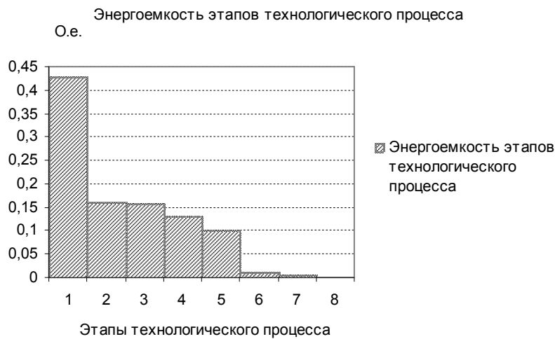
Рис. 10.1. Функция распределения энергозатрат при производстве хлеба (этапы технологического процесса расположены в порядке убывания энергоемкостей)
