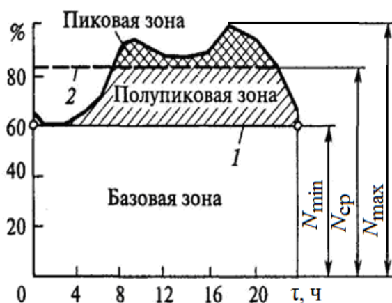
Рис. 1.7. Основные зоны графика электрической нагрузки: 1 – минимальная нагрузка; 2 – средняя нагрузка
