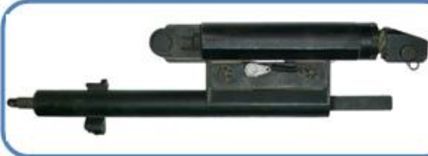
Механизм ручного заряжания и перезаряжания с откатником
