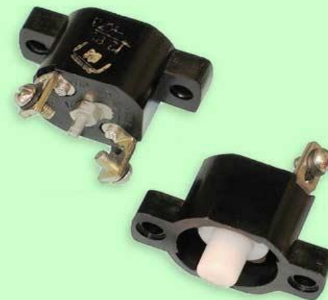
Рис. 4. Термобиметаллические предохранители типа ПР2Б, ПР3, ПР310, ПР315 однократного действия: 1 - выводы; 2 - пластина; 3, 4 - контакты; 5 - биметаллическая пластина; 6 - корпус; 7 - кнопка; 8 - пружина; 9 - контргайка; 10 - регулировочный винт
