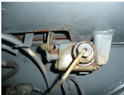
Заслонка воздухопритока вентиляции отделения управления с механизмом закрывания
