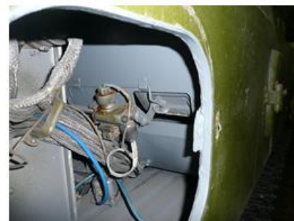
Заслонка воздухооттока вентиляции отделения управления с механизмом закрывания
