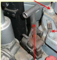
Т-образная рукоятка ГПН в положение «СИЛОВАЯ»
