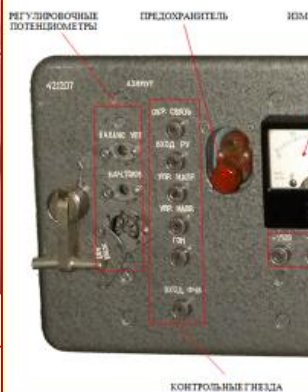
БЛОК СОПРОВОЖДЕНИЯ ПО УГЛОВЫМ КООРДИНАТАМ Т-13М2
