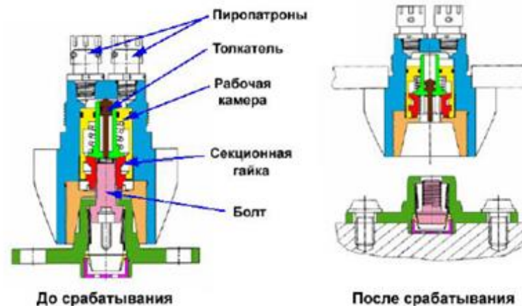
Пиропатроны ППС и ПП-9-2А Внешний вид (слева) и устройство пиропатронов ППС (в центре) и ПП-9-2А (справа).
