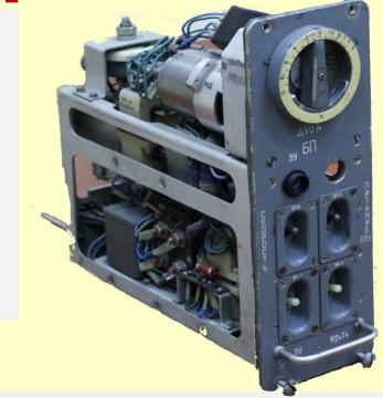
**Трансформатор** -  $T_p 2$  предназначен для получения питающих напряжений 6,3 В 400 Гц и 40 В 400 Гц при подаче на его первичную обмотку 115В 400 Гц. **Механизм**  $\Delta V_0$  - служит для ввода поправки на изменения начальной скорости
