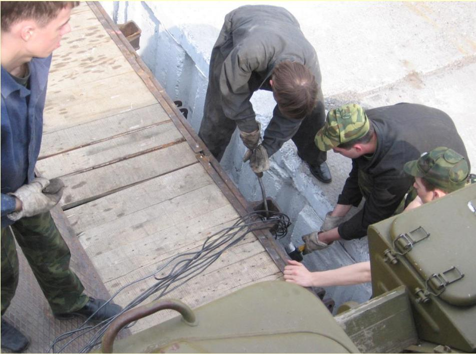
**Растяжка** - средство крепления, закрепляемое одним концом за увязочное устройство на грузе, другим - за специально предназначенное для этого увязочное устройство на кузове вагона.
