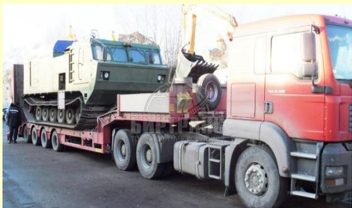
**Трал** - открытая низкорамная платформа, на которой можно размещать технику с размерами, превышающими размер такой платформы. Для транспортировки танков и другой тяжёлой военной техники нужны **тралы** со значительным количеством осей, так как допустимая нагрузка на одну ось не может превышать 10 тонн.
