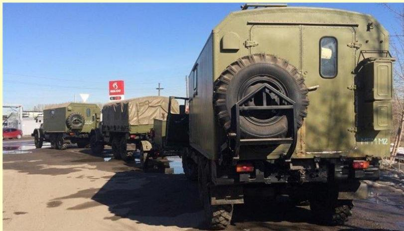
Изделие КРАС-1РШМ (контрольно-ремонтная автомобильная станция) служит:
