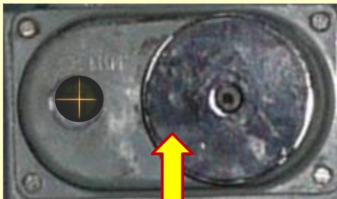
Переключатель “Сетки” положение - +
