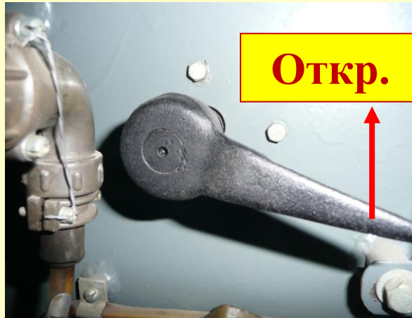
Рукоятка открывания, установлена на бронированной перегородке боевого отделения
