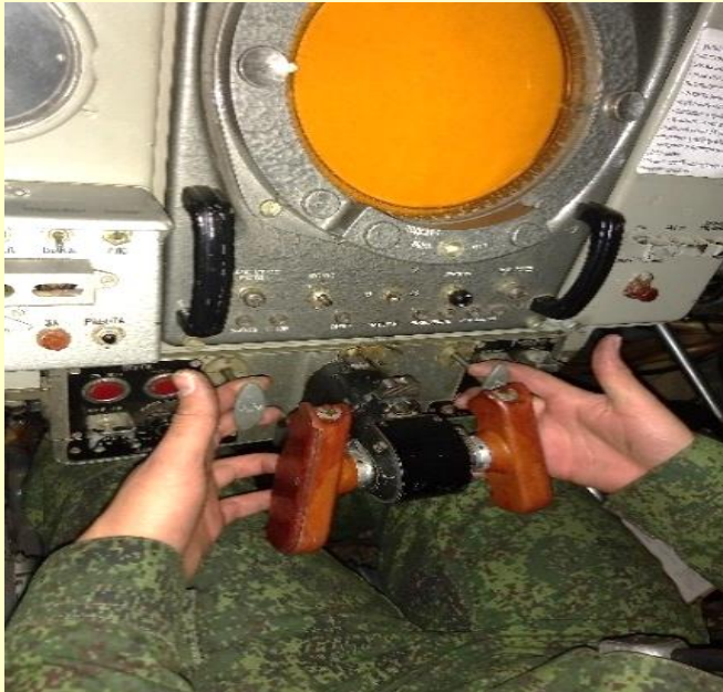
Ручки ПОЛУАВТ. АЗ и УМ – « вытянуть на себя ».
