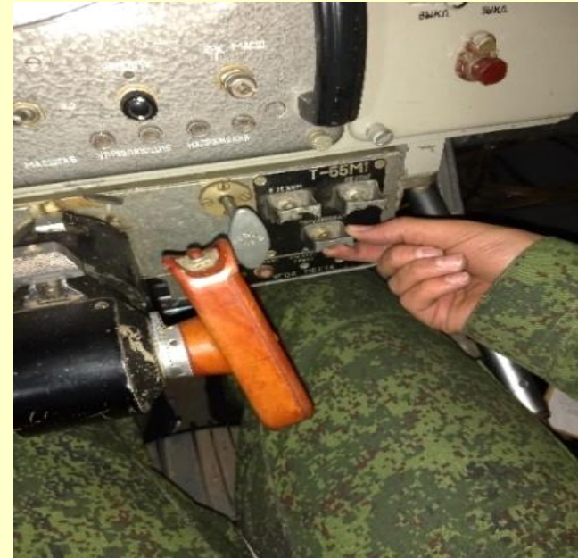
Тумблер ПОЛУАВТ. - АВТ.ГП - « ПОЛУАВТОМАТ »
