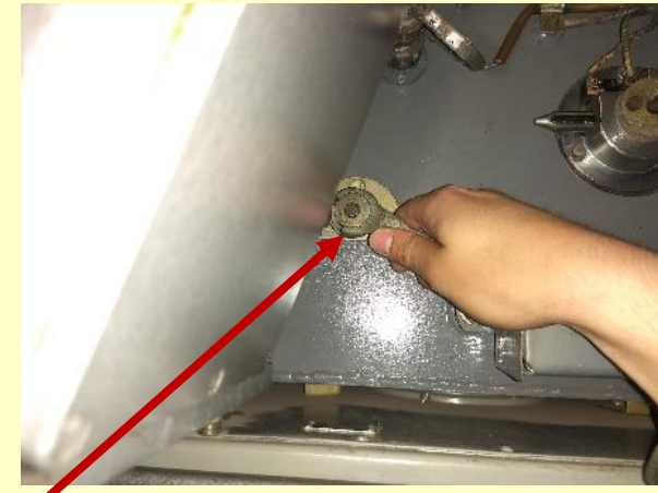
Рукоятка открывания, установлена на бронированной перегородке боевого отделения
