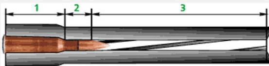
Разрез ствола нарезного оружия:
