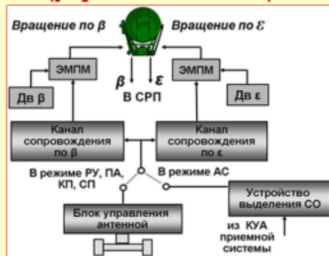
Система управления антенной (упрощенная схема)
