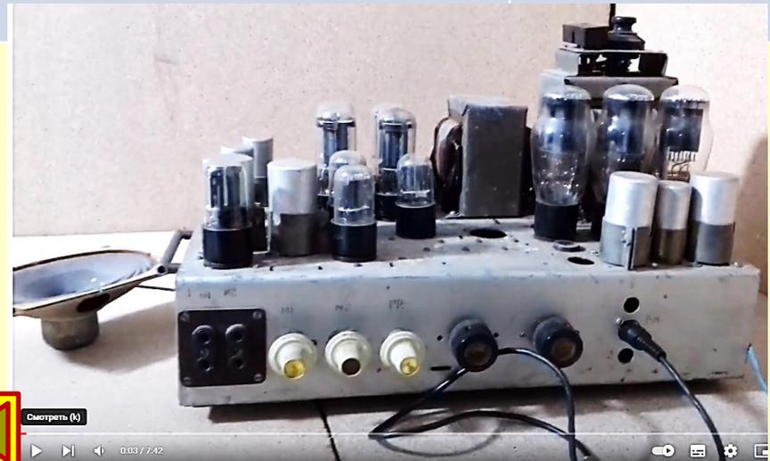
Урок 303. Вакуумный триод. Усилитель на вакуумном триоде
