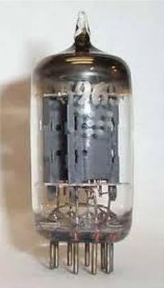
**Баллон** - представляет собой стеклянную, **металлическую** или **керамическую колбу**, внутри которой в **высоком вакууме** смонтированы **электроды**.
