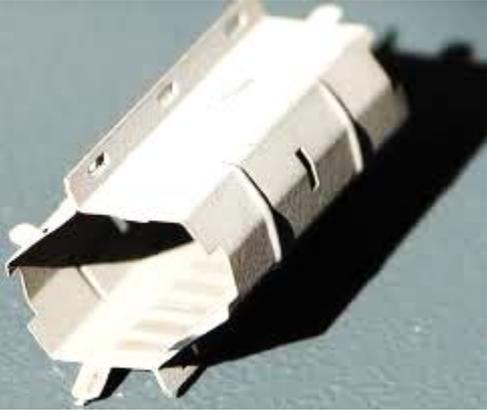
**Анод** - служит для притягивания электронов, излучаемых катодом.
