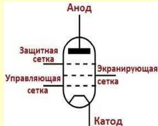
*Защитная сетка изготавливается из тонкой проволоки, имеет большой шаг намотки и располагается между анодом и экранирующей сеткой, соединяется с катодом и по этому имеет отрицательный заряд по отношению к аноду.*
