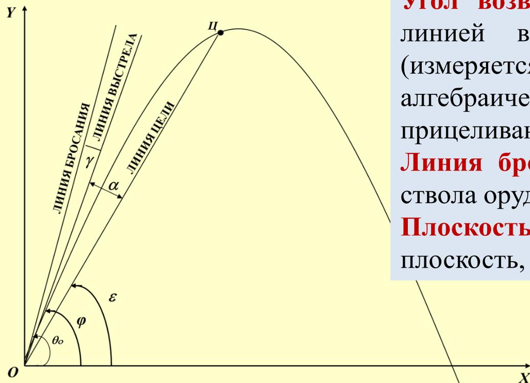
**Угол возвышения  $\varphi$**  - угол, составленный линией выстрела и горизонтом орудия; (измеряется от горизонта). Равен алгебраической сумме углов места цели и прицеливания  $\varphi = \varepsilon + \alpha$
