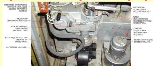
**Магнетрон применяется:** - в РЛС 1РЛ33М ЗСУ-23-4М «Шилка». **Магнетрон** волноводом подсоединен к антенне. Он управляется короткими высокоинтенсивными импульсами подаваемого напряжения, в результате чего излучается короткий импульс СВЧ энергии. Небольшая порция этой энергии отражается от ВЧ, принимается антенной и по волноводу направляется к чувствительному приёмнику. Сигнал, после дальнейшей обработки, появляется на индикаторе РЛС.
