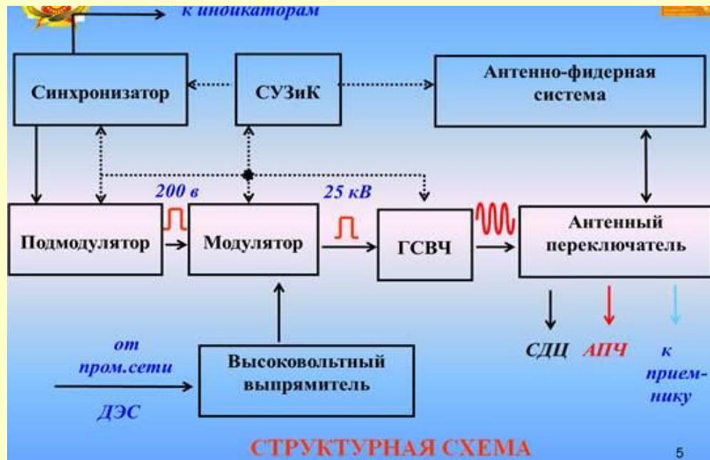
2) Энергия модулятора подводится к **генератору СВЧ** в виде высоковольтного напряжения (амплитудой десятки кВ).
