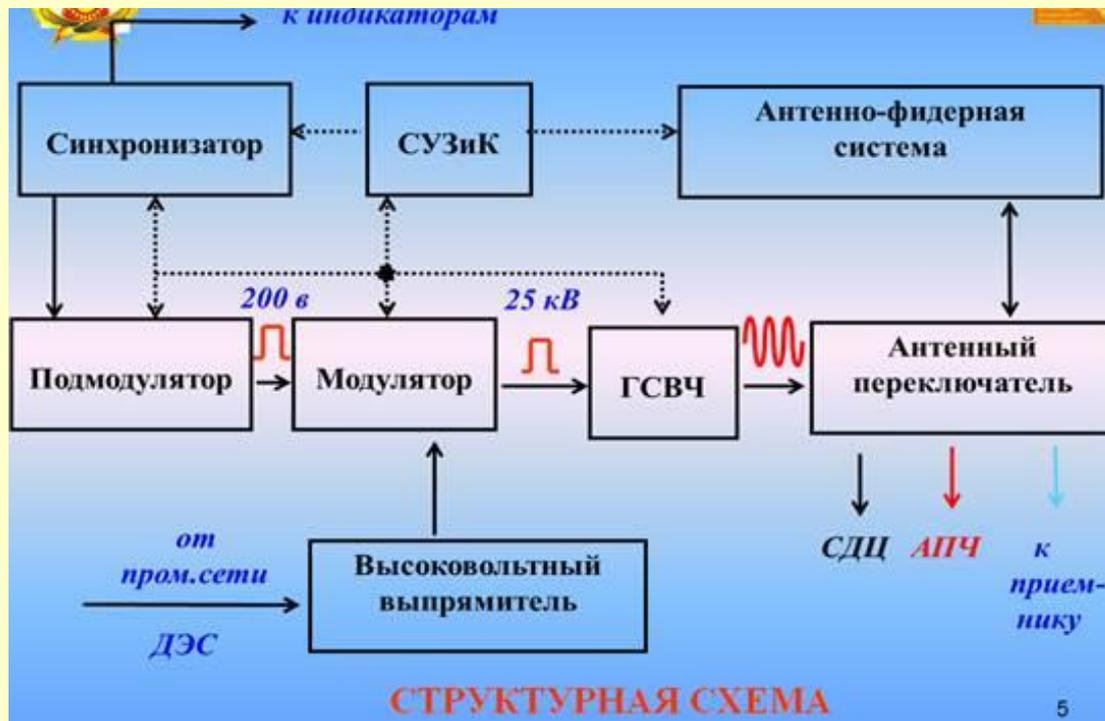
1) При включении **источника питания** его энергия накапливается в **модуляторе**. **Синхронизатор** вырабатывает импульсы запуска малой амплитуды, которые подаются в **подмодулятор** и в **индикаторы** РЛС для запуска разверток по дальности.
