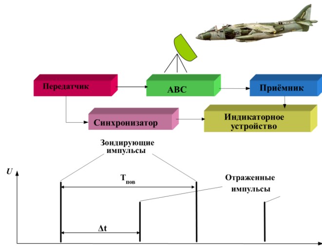
Рис. 29. Структурная схема РЛС активной радиолокации
