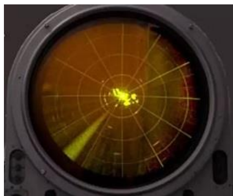
Рис. 131. Вид экрана ИКО при действии амплитудно-модулированной (шумовой) помехи
