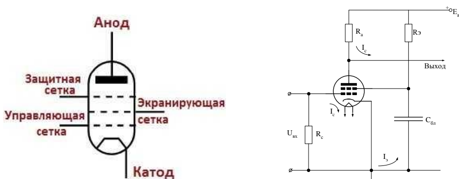
Рис. 73. Условное обозначение пентода и схема его включения
