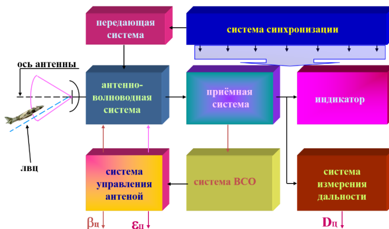
Рис. 34. Структурная схема импульсной РЛС
