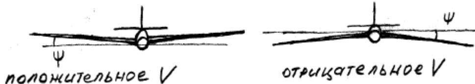
**Углом поперечного V** крыла называется угол между поперечной осью самолета и нижней поверхностью крыла (Рис. 23). У современных самолетов угол поперечного V колеблется от  $+5^\circ$  до  $-15^\circ$ .
