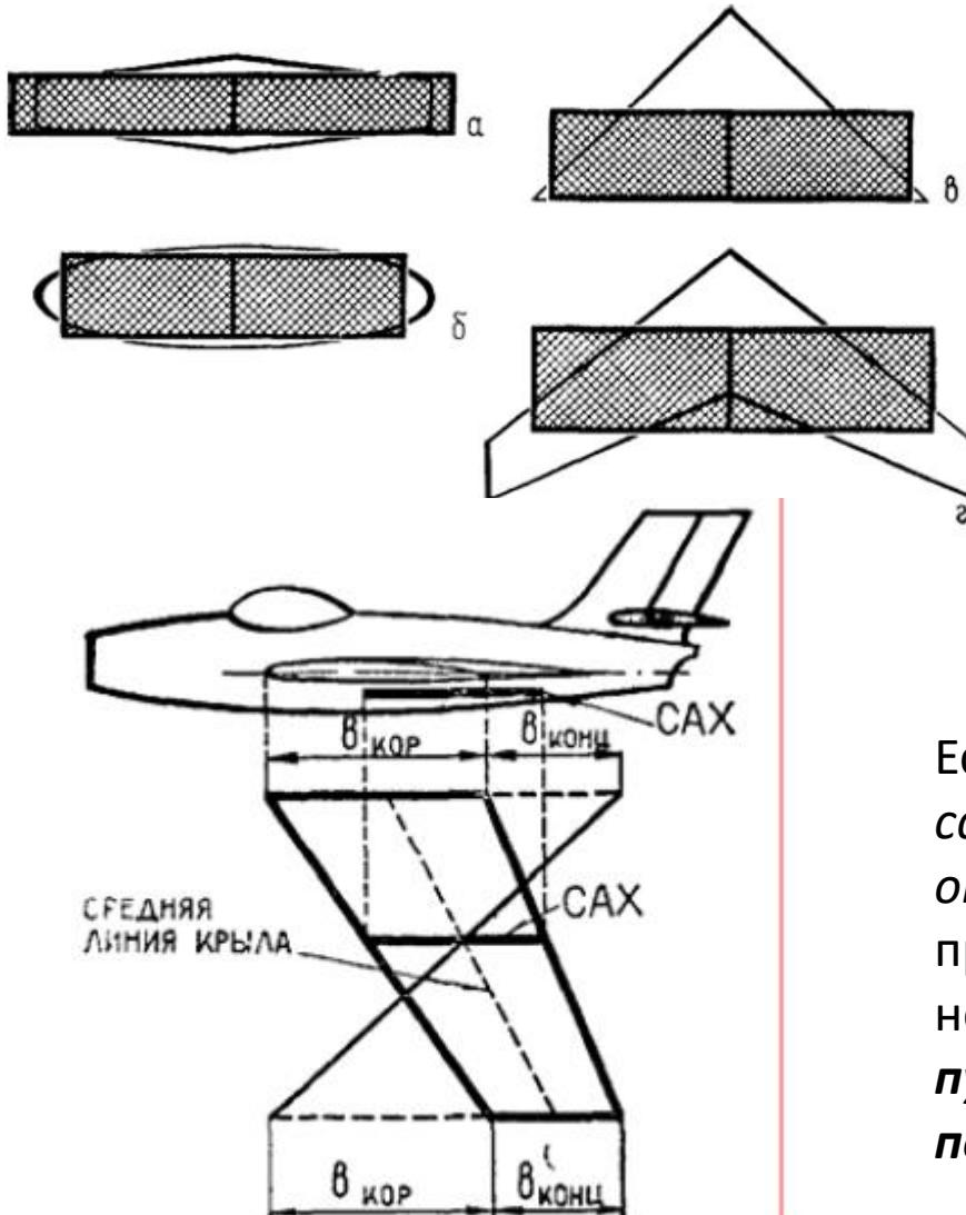
**Средней аэродинамической хордой крыла (САХ) называется хорда такого прямоугольного крыла, которое имеет одинаковые с данным крылом площадь, величину полной аэродинамической силы и положение центра давления (ЦД) при равных углах атаки**
