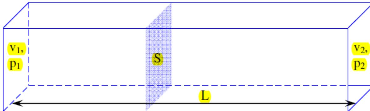
Рис. 4.3. Расчетная схема для вывода уравнения неразрывности
