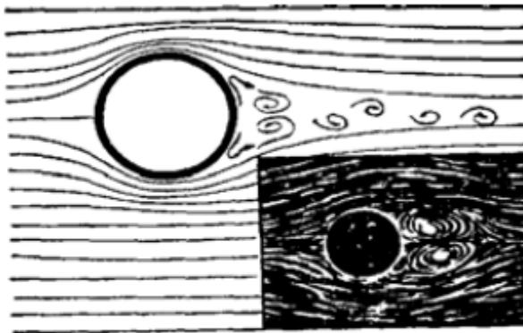
*Рис. 17 Аэродинамический спектр плоской пластинки и шара*
