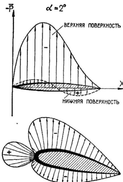
Кроме сил давления, на поверхность крыла по касательной к ней действуют силы трения, которые обусловлены вязкостью воздуха и целиком определяются процессами, происходящими в пограничном слое. Суммируя распределенные по поверхности крыла силы давления и трения, получим равнодействующую силу, которая называется **полной аэродинамической силой**. Точка приложения полной аэродинамической силы на хорде профиля крыла называется **центром давления**.
