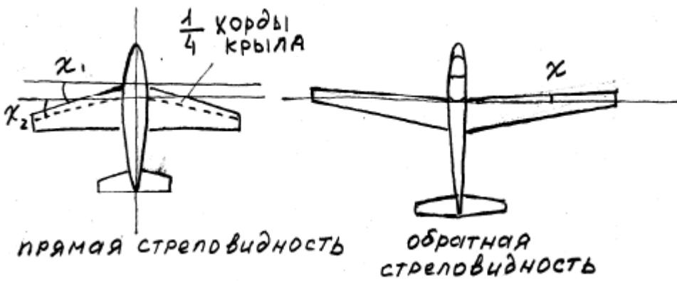
**Углом стреловидности**  $\chi$  называется угол между линией передней кромки крыла и поперечной осью самолета. Стреловидность также может быть замерена по линии фокусов (проходящей на расстоянии  $1/4$  хорды от ребра атаки) или по другой линии крыла. Для околозвуковых самолетов она достигает  $45^\circ$ , а для сверхзвуковых - до  $60^\circ$
