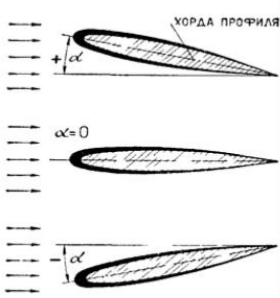
Установочным углом называется угол между продольной осью ЛА и хордой крыла. Этот угол выбирается таким, чтобы на крейсерской скорости полёта угол атаки имел оптимальное значение, а фюзеляж ЛА создавал минимальное сопротивление.
