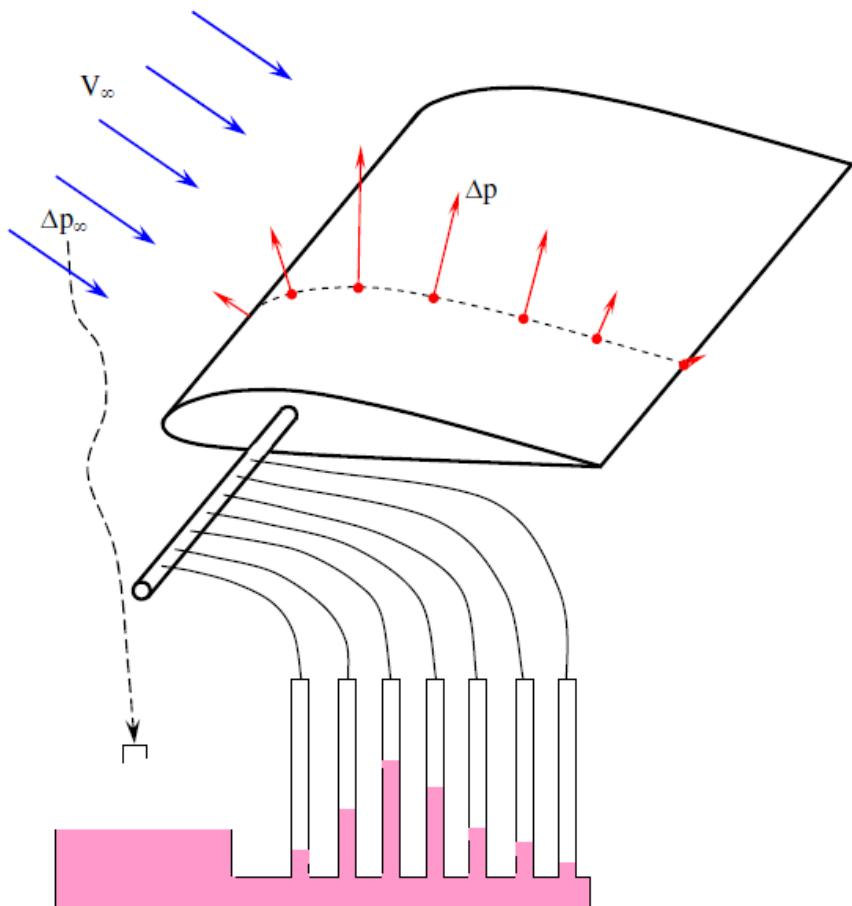
Если поместить в поток крыло бесконечного размаха – на верхней и нижней поверхности крыла изменяется статическое давление. Изменение давления вблизи профиля можно охарактеризовать коэффициентом давления
