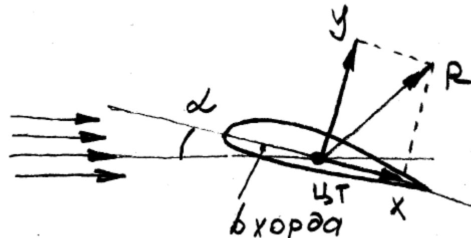
Углом атаки крыла называется угол между хордой крыла и направлением скорости набегающего потока
