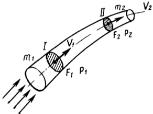
*Рис. 9 Пояснение к закону неразрывности струи воздушного потока*
