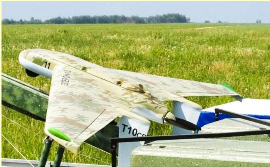
Следующий по увеличению размерности беспилотников в линейке компании «Эникс» — комплекс «Элерон-10СВ» с беспилотным летательным аппаратом Т-10. Он появился одновременно с моделью «ЗСВ».
