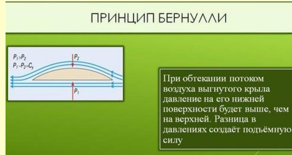
При переходе жидкости с участка трубы с большим сечением на участок с меньшим, скорость течения возрастает, т.е. жидкость движется с ускорением. Тот же самый принцип справедлив и для газа.
