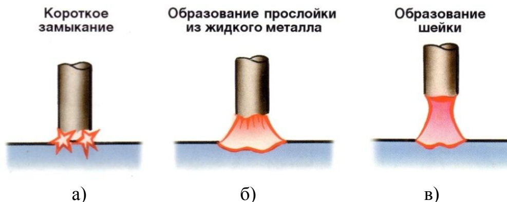
Рис. 2.4. Возбуждение сварочной дуги
