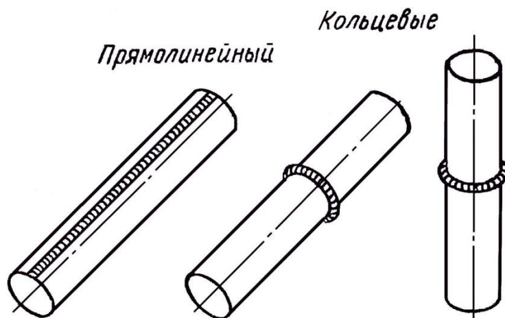
Рис. 1.8. Виды сварных швов по направлению
