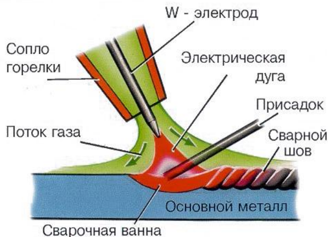
Рис. 2.67. Расположение горелки и присадочного прутка при ручной аргонодуговой сварке
