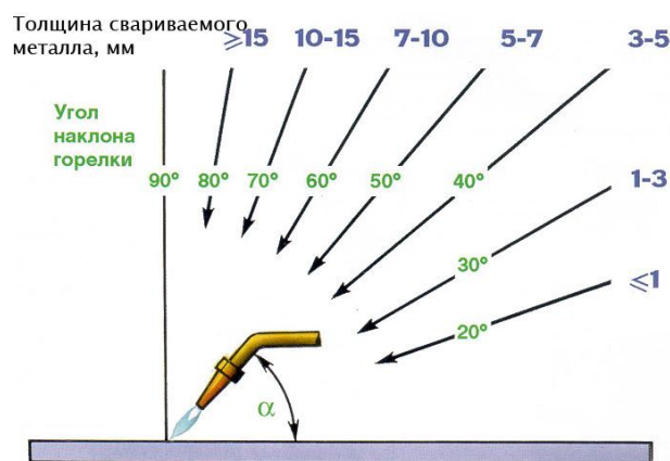
Рис. 3.7. Углы наклона мундштука горелки в зависимости от толщины металла при сварке низкоуглеродистой стали
