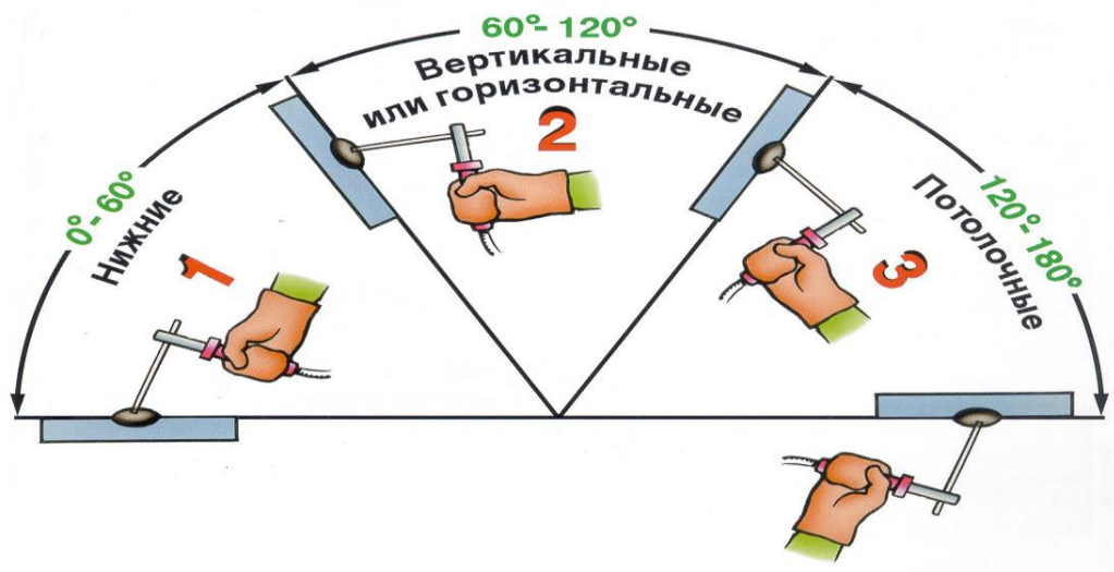
Рис. 1.5. Пространственное положение сварных швов
