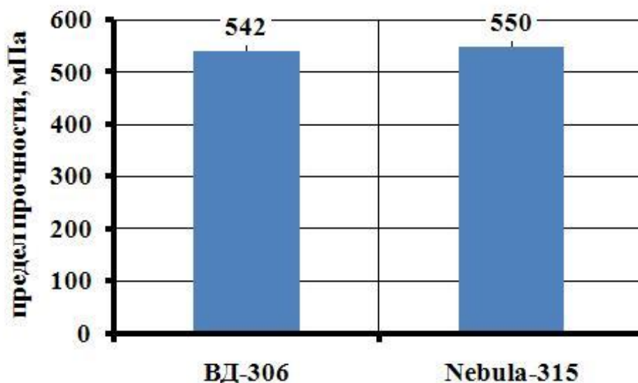
Рис. 9.22. Влияние типа источника питания на предел прочности при растяжении сварных соединений из трубы 159х6, сталь 09Г2С, электроды: корень – LB-52U ( d=2,6 мм); заполнение: LB-52U ( d=3,2 мм)
