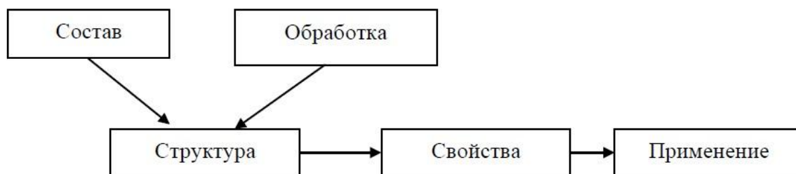
Рис. 1.1. Схема связей между характеристиками материала
