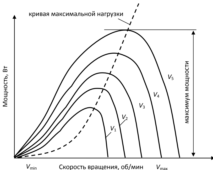
Рис. 2. Типичные зависимости выходной мощности ВЭУ от величины нагрузки
