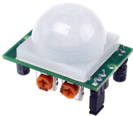
PIR-датчики с линзой Френеля
