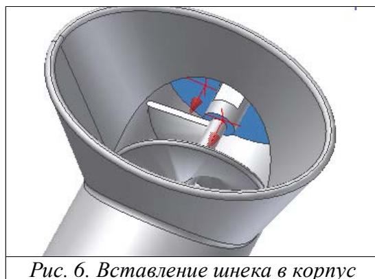
Рис. 6. Вставление шнека в корпус
