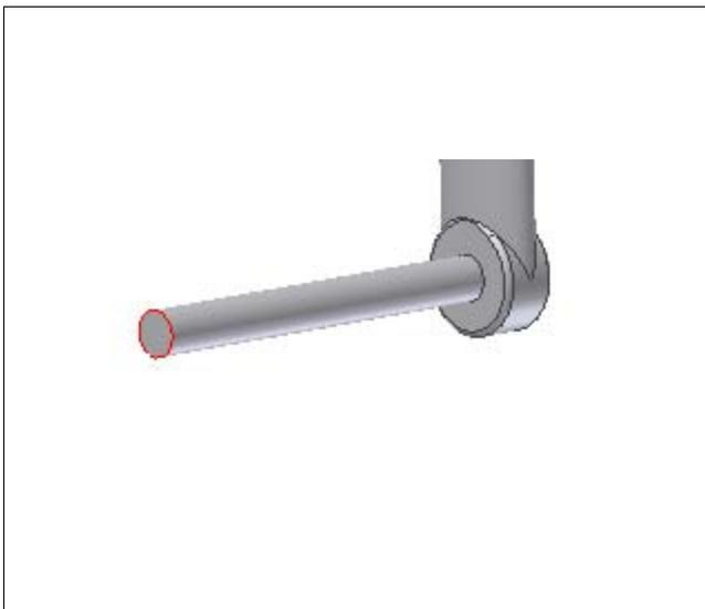
Рис. 4. Базовая поверхность.
