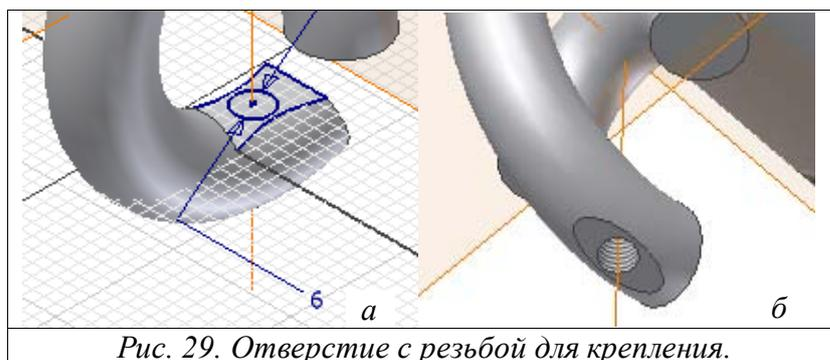
Рис. 29. Отверстие с резьбой для крепления.
