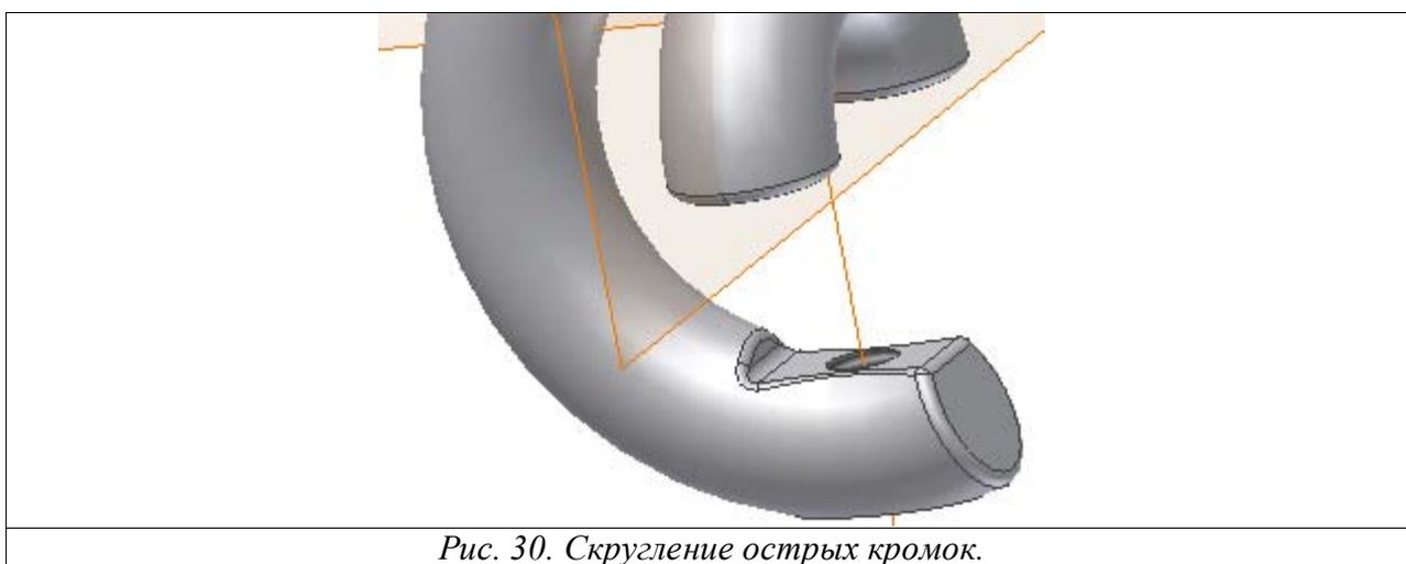
Рис. 30. Скругление острых кромок.
