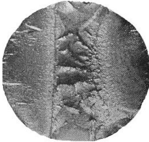
*Рис. 6. Усталостный излом штока компрессора*
