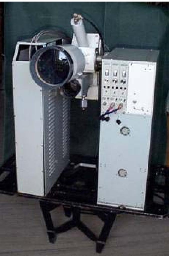
При дистанционном зондировании морской акватории лидар способен: обнаруживать наличие косяков рыбы в приповерхностном слое моря; измерять прозрачность воды (показатель ослабления излучения); детектировать наличие нефтяной пленки на поверхности воды и хлорофилла фитопланктона в ней; измерять глубину дна на мелководье.
