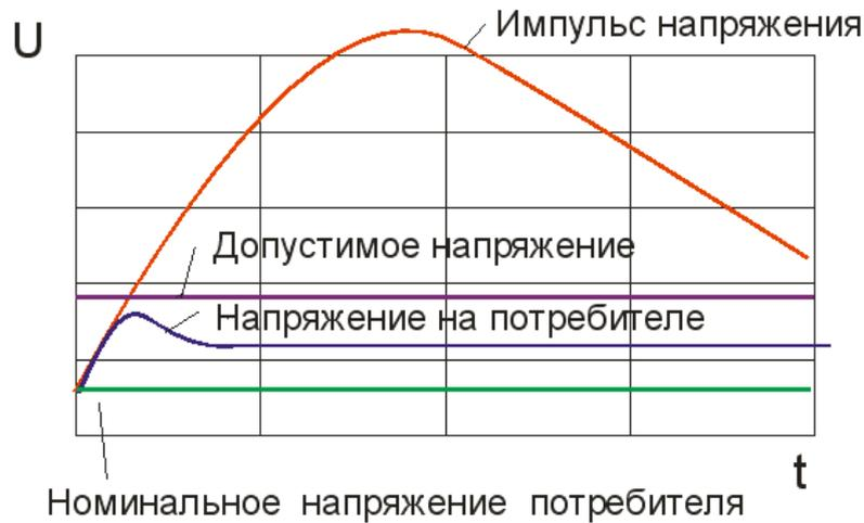
Рис. 4.11. Ограничение импульса перенапряжения варистором
