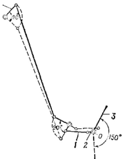
Рис. 2.5. Рычажный привод разъединителя
