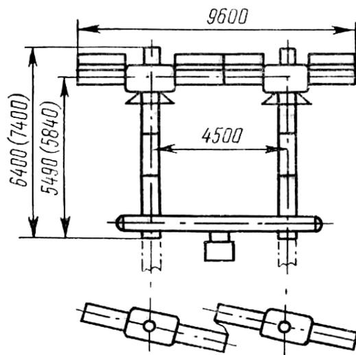
Рис. 1.18. Воздушный выключатель серии ВНВ на 330 кВ
