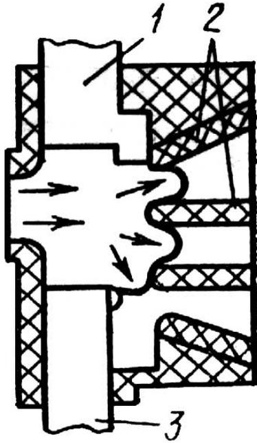
Рис. 1.14. Дугогасительная система с поперечным воздушным дутьем
