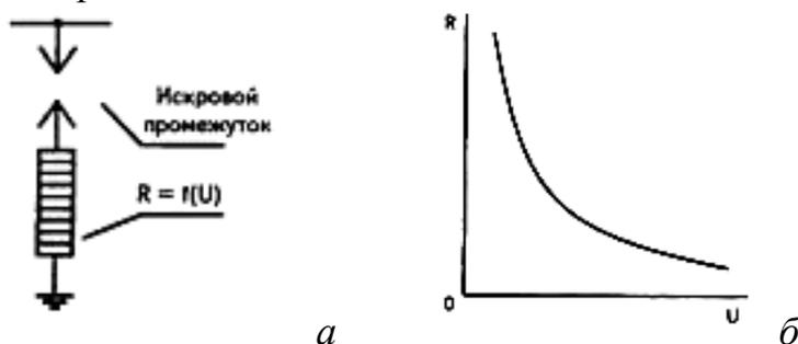
Рис. 4.1. Вентильный разрядник: а - схема; б - защитная характеристика
