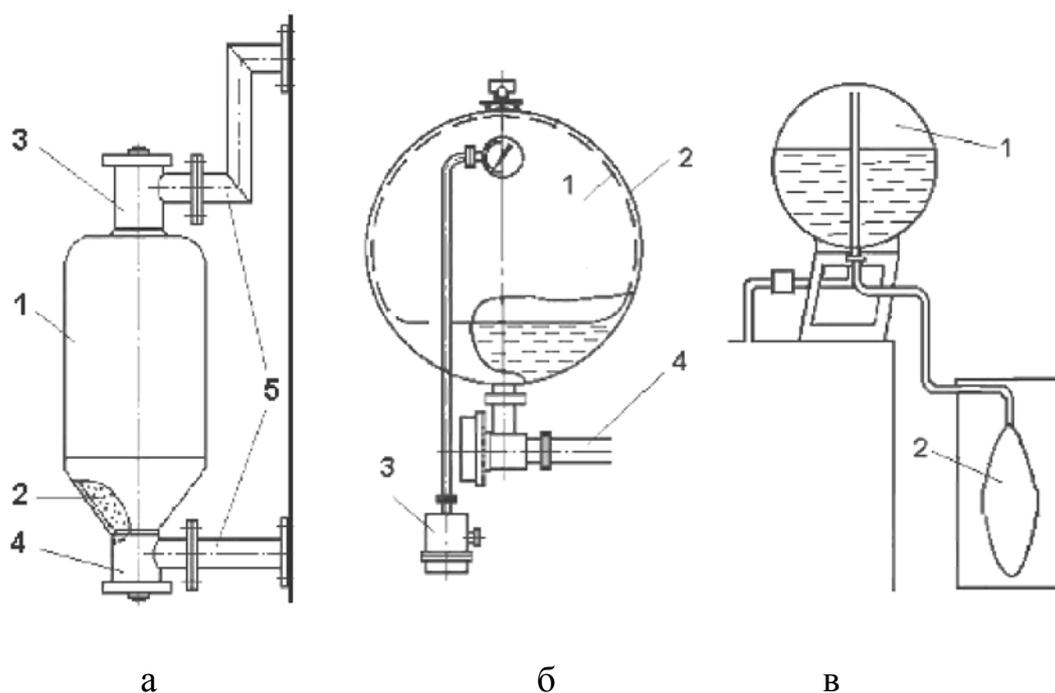
Рис. 6.5. Термосифонный фильтр (а), принципиальные схемы пленочной (б) и азотной (в) защит масла
