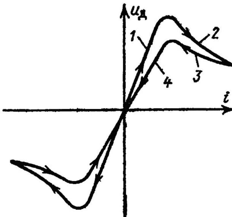
Рис. 1.4. Вольт-амперная характеристика дуги при переменном токе
