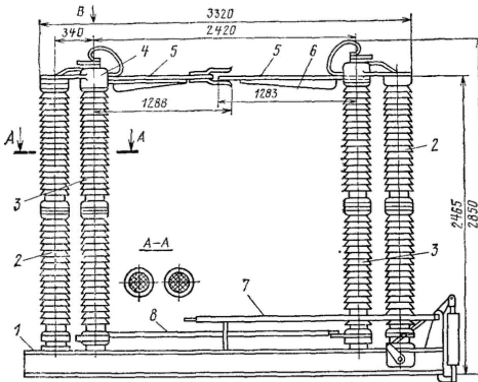
Рис. 2.7. Разъединитель типа РНДЗ-1
