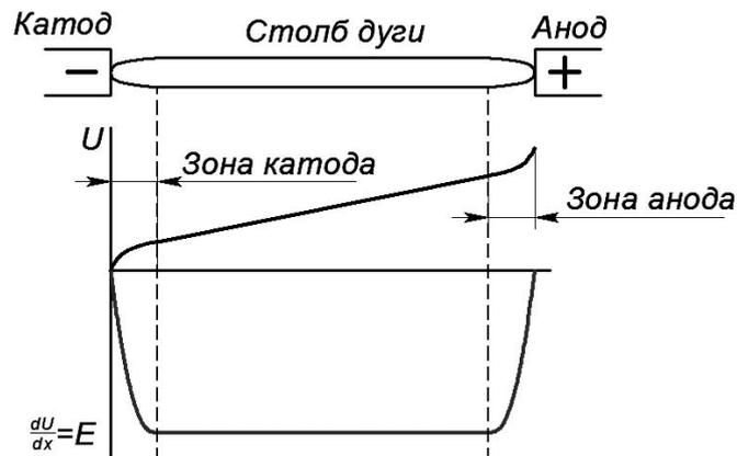
Рис. 1.1. Распределение напряжения и напряженности поля вдоль дугового канала
