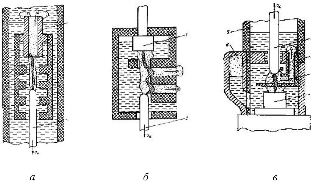
Рис.1.8. Схемы конструкций дугогасительных устройств с автодутьем в масле: 1 – неподвижный контакт, 2 – подвижный контакт, 3 – дутьевой канал, 4 – дутьевая щель, 5 – надкамерное пространство, 6 – буферная область (воздушная подушка)
