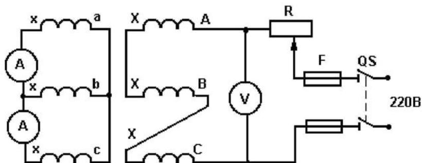
Рис. 6.9. Схема сушки изоляции ТН нагрузочными токами
