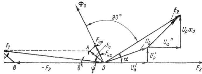
Рис. 3.2. Векторная диаграмма трансформатора тока
