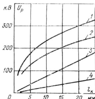
Рис. 1.24. Зависимости разрядных напряжений в однородном поле от расстояния между контактами для различных изоляционных сред:
