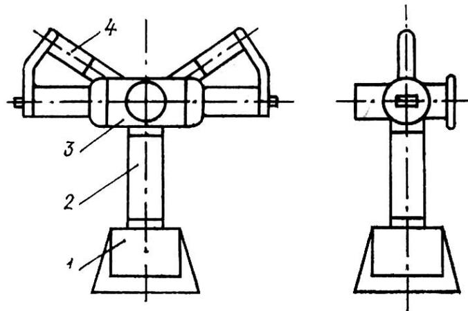
Рис. 1.17. Воздушный выключатель серии ВВБ на 110кВ
