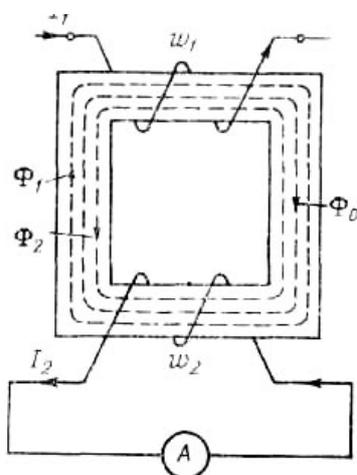
Рис. 3.1. Схема трансформатора тока
