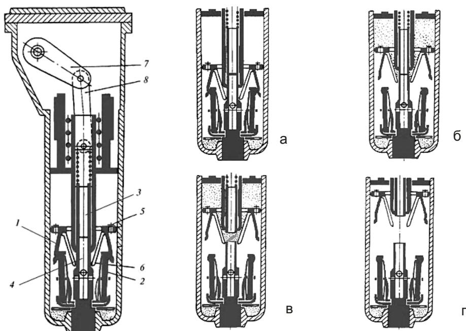
*Рис. 1.21. Автокомпрессионный элегазовый выключатель фирмы Merlin Gerin*
