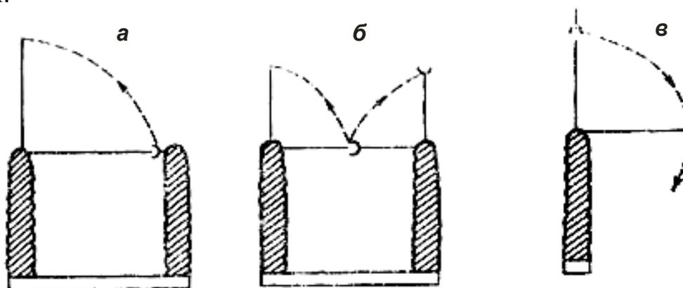
*Рис. 2.1. Вертикально-поворотные разъединители и разъединители со сложной конструкцией ножей:
