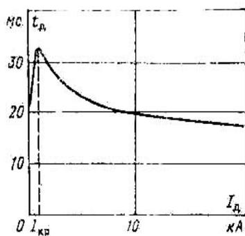
Рис. 1.10. Зависимость времени гашения дуги от тока отключения в маломасляном выключателе ВМП
