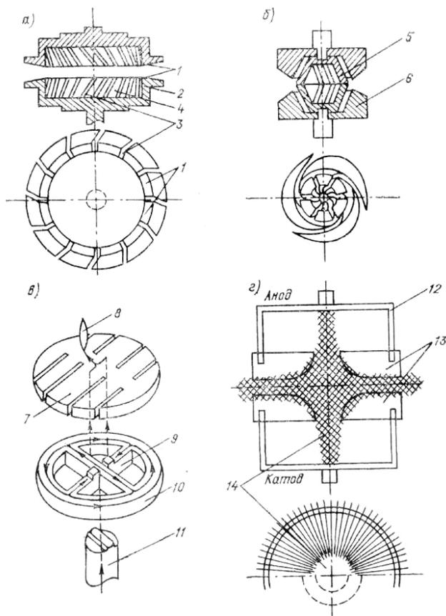
Рис. 1.25 Конструкции контактов ВДК с поперечным (а, б), продольным (в) магнитным полем и с искусственно увеличенной рабочей поверхностью (г):
