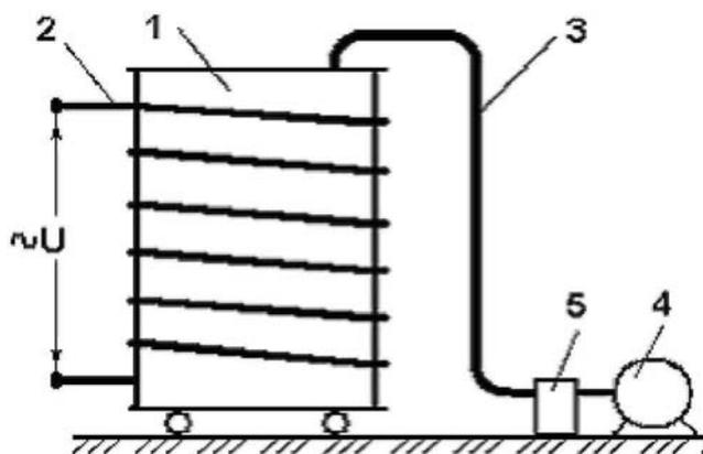
Рис. 6.6. Принципиальная схема сушки изоляции трансформатора
