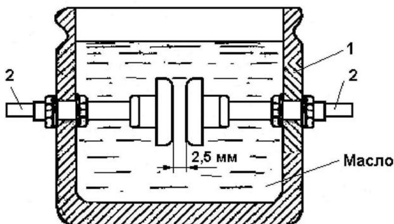
Рис. 6.4. Стандартный маслопробойник
