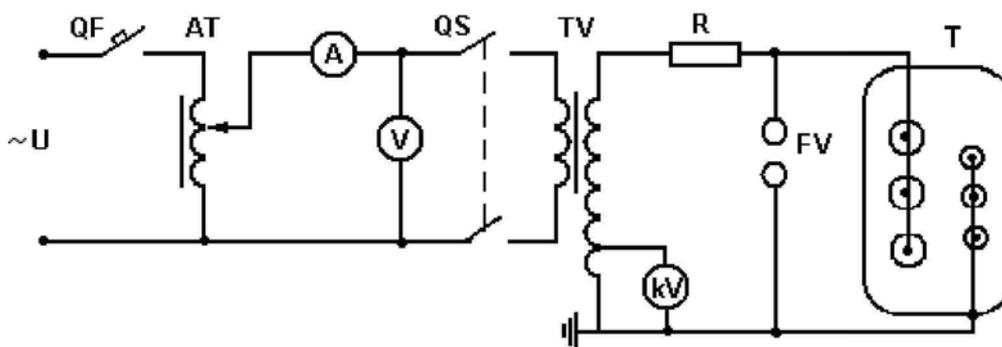
Рис.6.7. Принципиальная схема испытания изоляции повышенным напряжением
