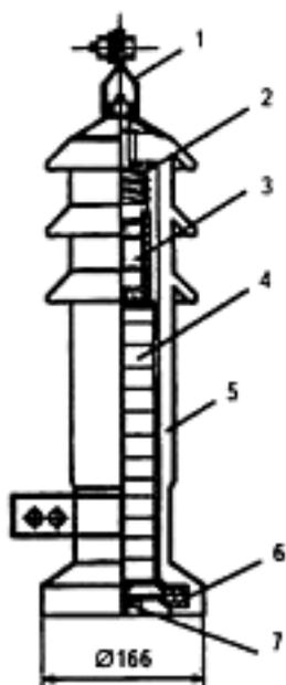
Рис. 4.3. Устройство вентильного разрядника серии РВП
