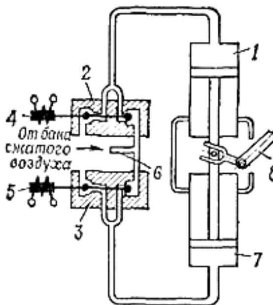
Рис. 2.6. Пневматический привод разъединителя
