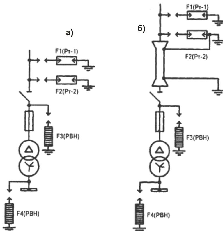
Рис.4.12. Схема защиты подстанции от перенапряжений:
