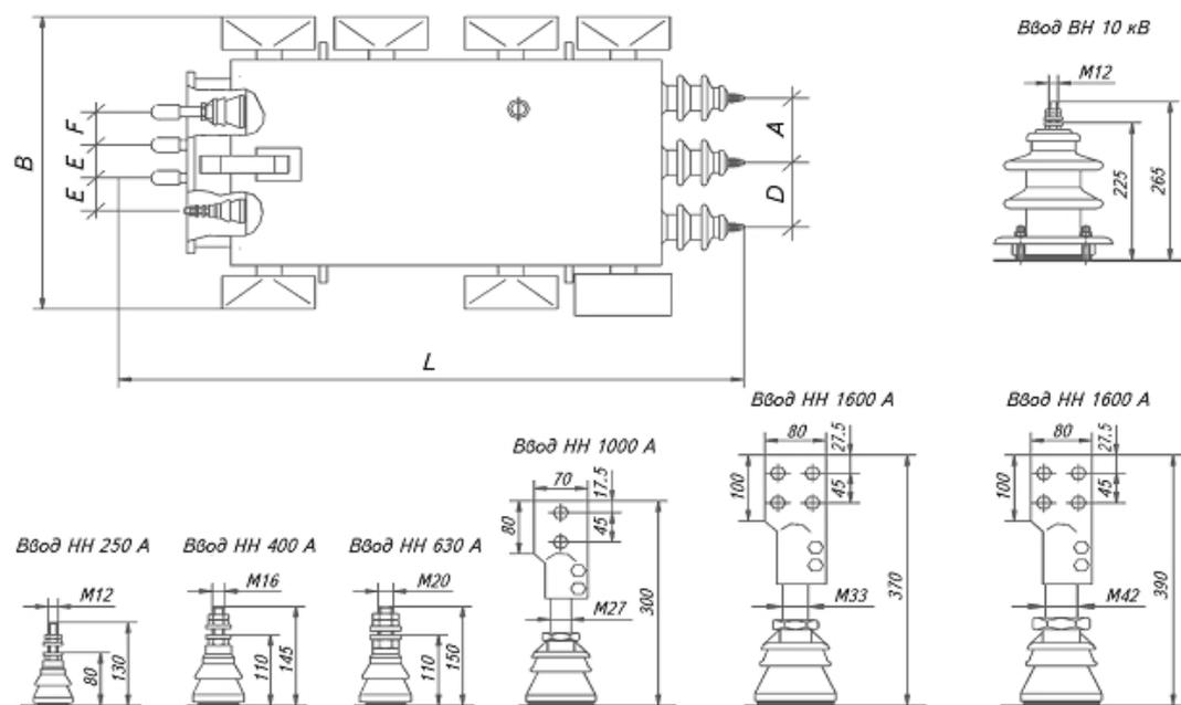
Рис. П4.1. Трансформаторы герметичные силовые масляные серии ТМЗ мощностью от 630 до 2500 кВ·А
