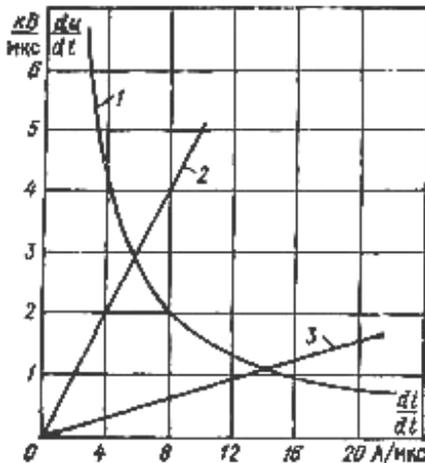
Рис. 1.15. Отключающая способность дугогасительного устройства воздушного выключателя: 1 - зависимость  $du/dt = f(di/dt)$  в воздухе при давлении 1,6 МПа; 2,3 - зависимости скорости восстановления напряжения при отключении не удаленного к. з. без шунтирующего резистора (прямая 2) и при наличии ШР с сопротивлением, равным 100 Ом (прямая 3)
