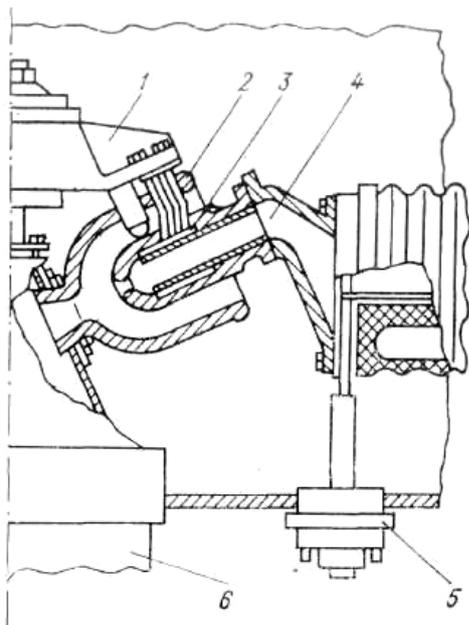
*Рис. 1.16. Конструкция дугогасительной камеры с несимметричным дутьем в металлической камере большого объема 1 – подвижная контактная траверса; 2,3 – неподвижные соплообразные контакты; 4 – канал; 5 – пневматический механизм управления клапаном дополнительного дутья; 6 – главный дутьевой клапан*
