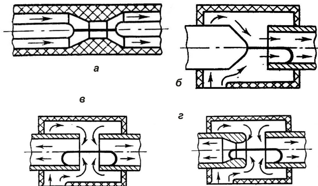
*Рис. 1.13. Дугогасительные системы воздушных выключателей: а – система продольного дутья между двумя сплошными контактами; б – система одностороннего продольного дутья между двумя контактами, один из которых сплошной, а другой полый; в – система двухстороннего продольного симметричного дутья между двумя полыми контактами одного внутреннего диаметра; г – система двухстороннего продольного несимметричного дутья между двумя полыми контактами с разными внутренними диаметрами*
