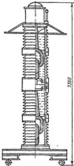
*Рис. 3.7. Двухступенчатый каскадный трансформатор тока. Общая компоновка*
