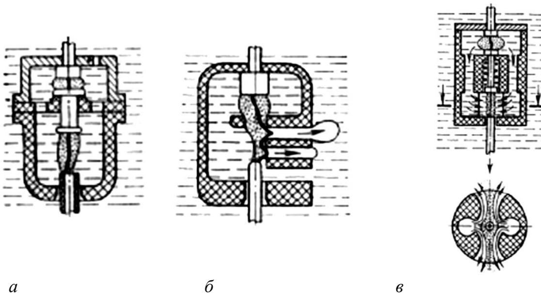
Рис 1.7. Схемы конструкций дугогасительных устройств с автодутьем в масле: а – с продольным масляным дутьем; б – с поперечным масляным дутьем; в – встречно-поперечного дутья
