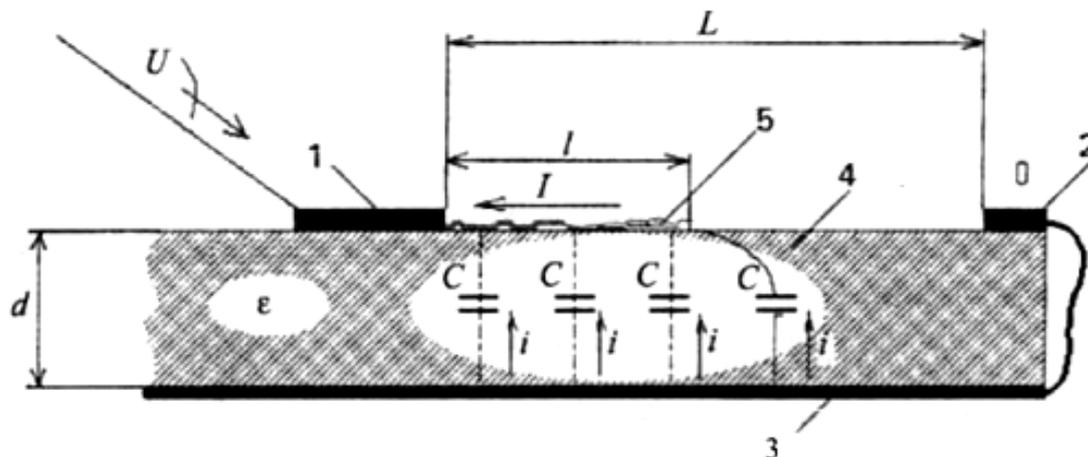
Рис. 4.4. Эквивалентная схема скользящего разряда:
