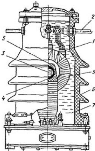
*Рис. 3.6. Трансформатор тока типа ТФН-35*
