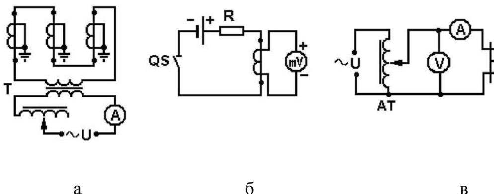
Рис. 6.8. Схемы сушки изоляции (а), определения полярности обмоток (б) и снятия характеристики намагничивания ТТ (в)
