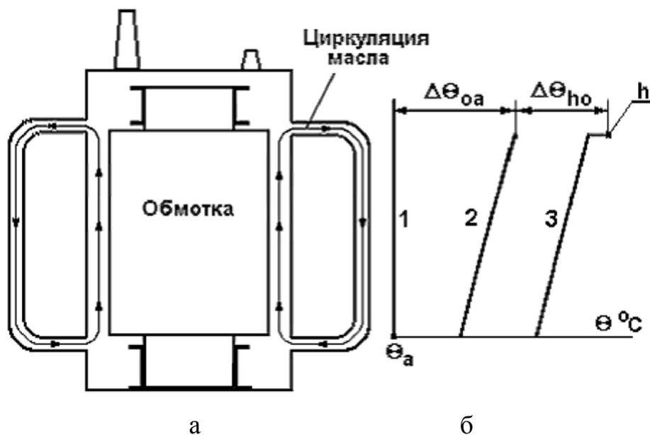
Рис. 6.3. Естественная циркуляция масла в трансформаторе (а)
