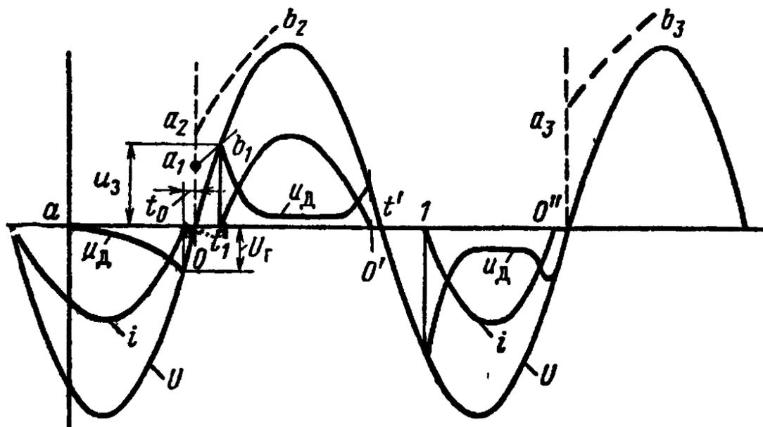
Рис. 1.3. Характер процессов при отключении цепи переменного тока
