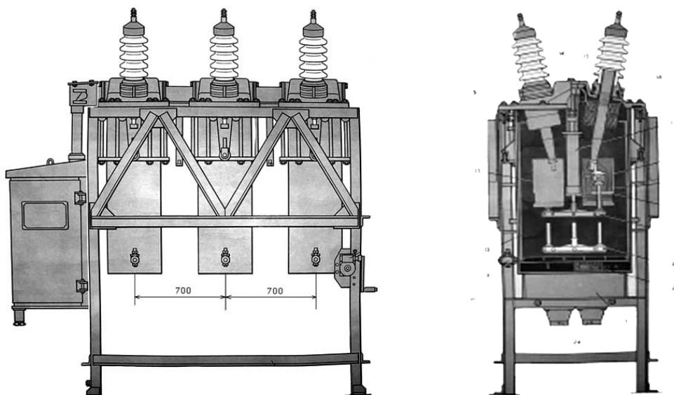
*Рис. 1.5. Конструкция бакового выключателя МКП-35-1000-25 на 35 кВ. Представляет собой три отдельных полюса, смонтированных на общем сварном каркасе*
