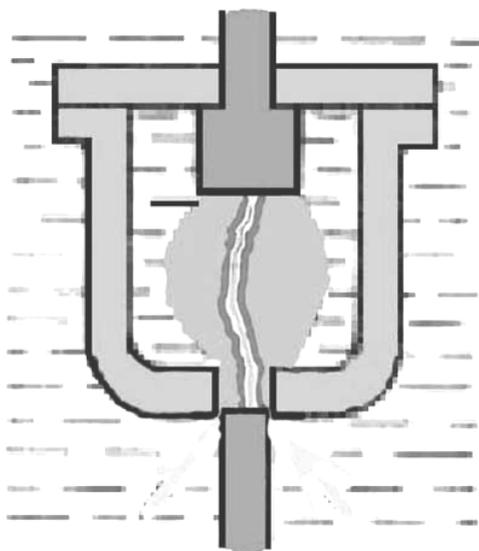
*Рис 1.6. Конструктивная схема простой дугогасительной камеры*
