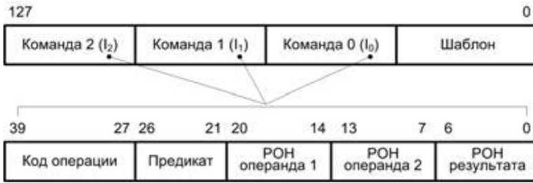
Рис. 9.40. Формат сверхдлинной команды в архитектуре IA-64
