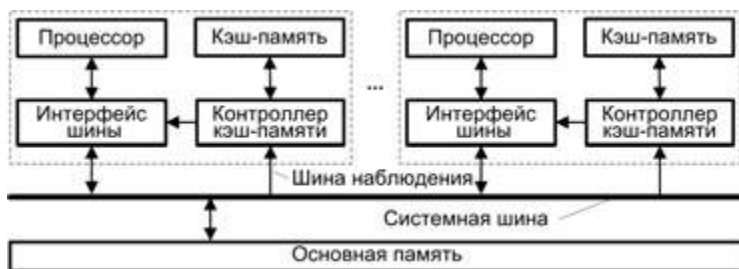
Рис. 11.11. Структура системы, обеспечивающей когерентность кэшей с помощью протокола наблюдения
