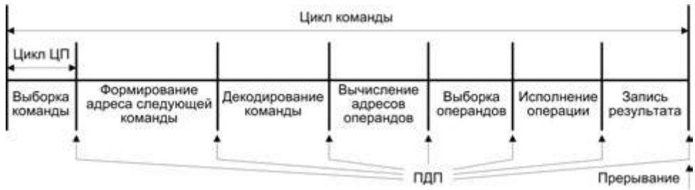
Рис. 8.8. Точки возможного вмешательства в цикл команды при прямом доступе к памяти и при обычном прерывании
