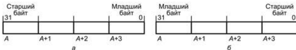
Рис. 2.26. Размещение в памяти 32-разрядного числа: а — начиная со старшего байта; б — начиная с младшего байта
