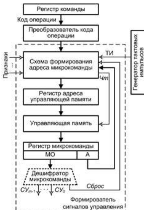
Рис. 4.6. Формирователь сигналов управления в микропрограммном автомате с программируемой логикой
