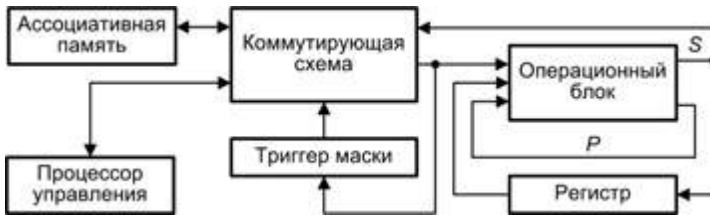
Рис. 13.19. Структура процессорного элемента поразрядно-последовательного ассоциативного процессора
