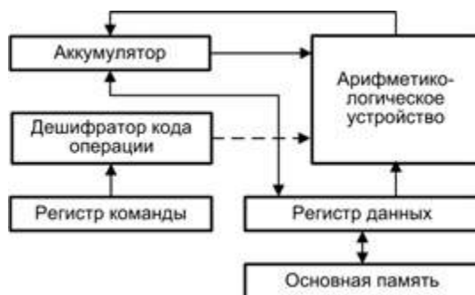
Рис. 2.7. Архитектура вычислительной машины на базе аккумулятора
