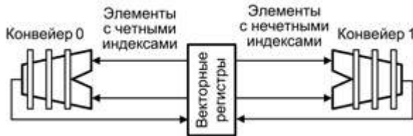
Рис. 13.10. Выполнение векторных операций при двух конвейерах
