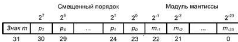
Рис. 5.51. Представление чисел в форме с плавающей запятой по стандарту IEEE 754 (одинарный формат)
