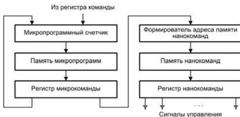
Рис. 4.8. Нанопрограммное устройство управления
