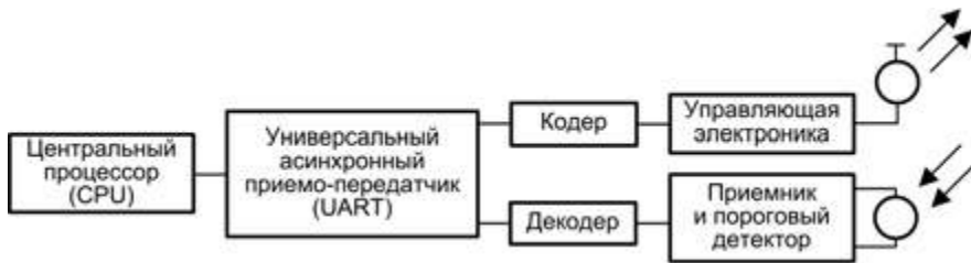
Рис. 7.21. Схема организации инфракрасной связи
