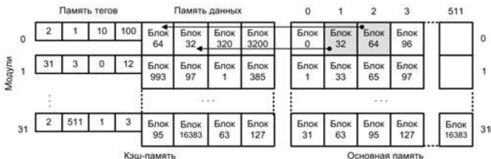
Рис. 6.33. Кэш-память с четырехканальным частично-ассоциативным отображением
