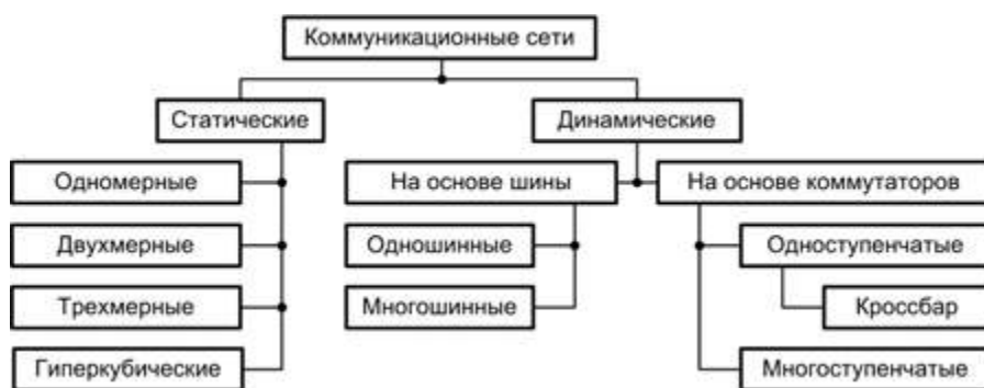
Рис. 12.2. Классификация коммуникационных сетей по топологии
