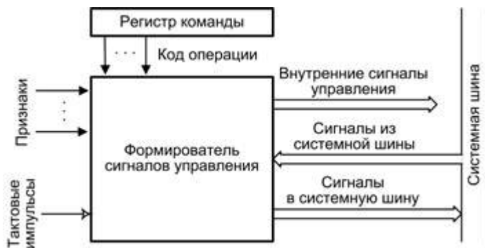
Рис. 4.2. Информационная модель микропрограммного автомата
