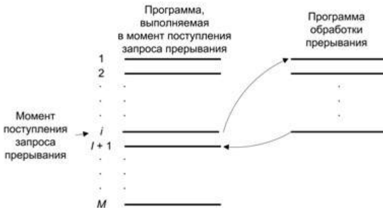
Рис. 4.11. Передача управления при прерываниях
