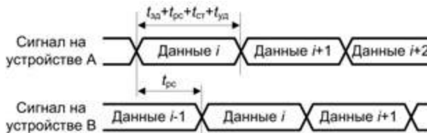
Рис. 7.15. Конвейеризация транзакций чтения
