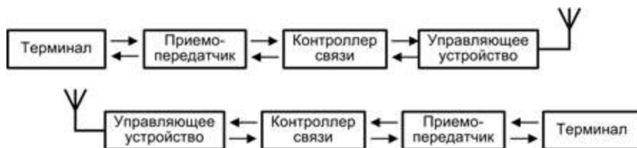
Рис. 7.20. Схема организации Bluetooth-связи
