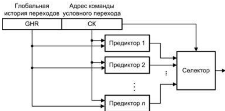
Рис. 9.20. Общая схема гибридного предиктора
