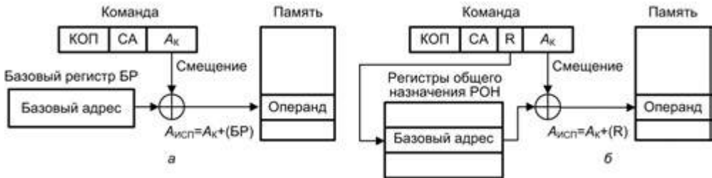
Рис. 2.47. Базовая регистровая адресация: а — с базовым регистром; б — с использованием одного из РОН
