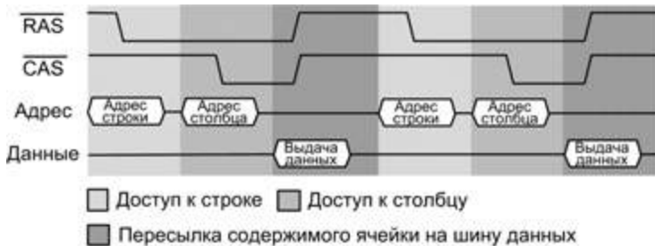
Рис. 6.7. Временная диаграмма «классической» процедуры чтения
