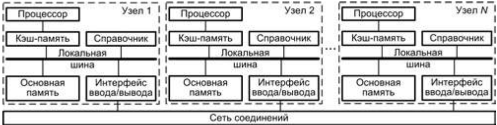
Рис. 14.4. Организация систем типа ccNUMA
