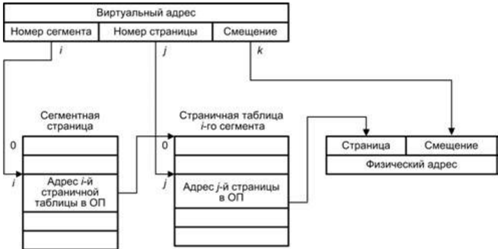
Рис. 6.38. Преобразование адреса при сегментно-страничной организации памяти
