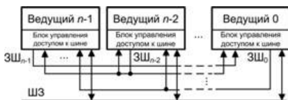
Рис. 7.11. Иллюстрация децентрализованного арбитража
