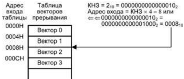
Рис. 4.16. Структура таблицы векторов прерывания
