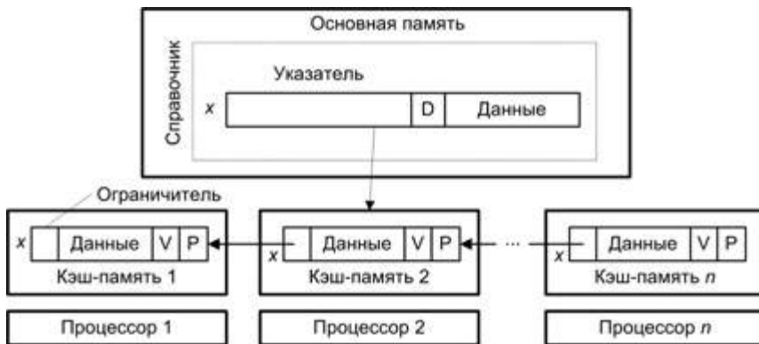
Рис. 11.20. Протокол обеспечения когерентности кэш-памяти со сцепленным справочником
