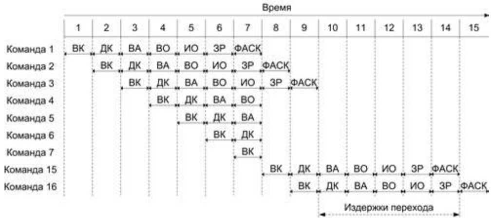
Рис. 9.5. Влияние команды условного перехода на работу конвейера команд
