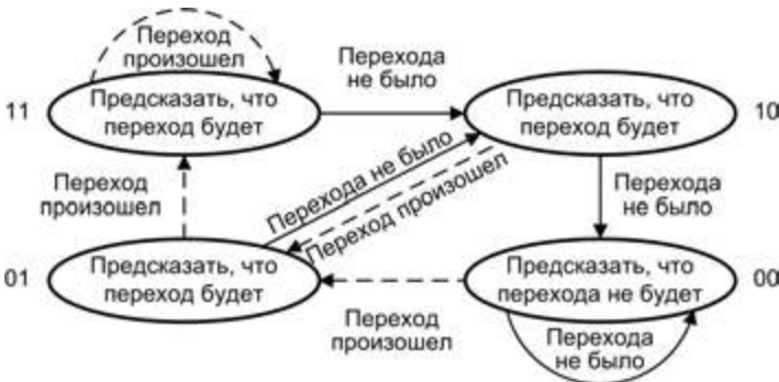
Рис. 9.7. Диаграмма состояний двухразрядного автомата А2
