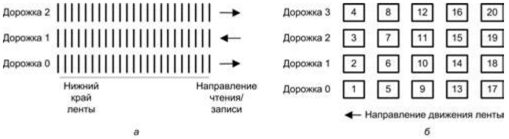
Рис. 6.60. Типовая организация хранения данных на магнитной ленте при линейном методе записи: а — серпантинное чтение и запись; б — расположение блоков в системе, где одновременно читаются 4 дорожки
