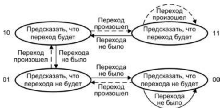
Рис. 9.8. Диаграмма состояний двухразрядного автомата А3
