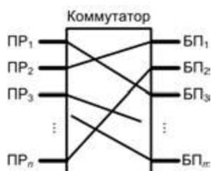
Рис. 11.4. UMA-система на базе коммутатора
