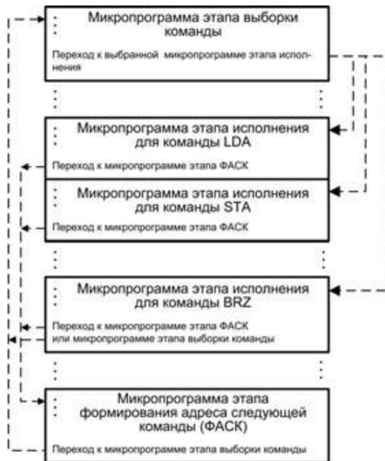
Рис. 4.5. Размещение микропрограмм в управляющей памяти
