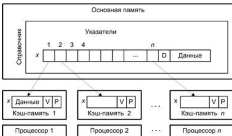
Рис. 11.19. Протокол обеспечения когерентности кэш-памяти с полным справочником
