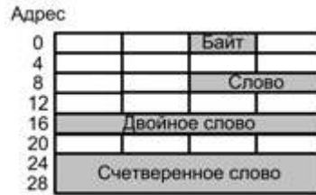
Рис. 2.27. Размещение чисел в памяти с выравниванием
