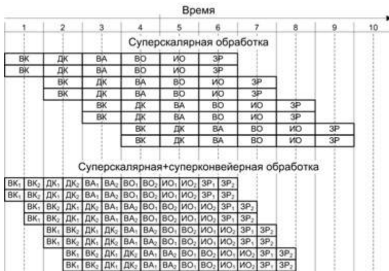
Рис. 9.29. Сравнение эффективности стандартной и совмещенной схем суперскалярных вычислений
