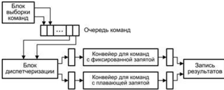
Рис. 9.26. Суперскалярный процессор с двумя конвейерами
