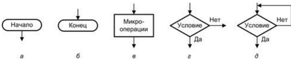
Рис. 3.3. Разновидности вершин граф-схемы алгоритма: а — начальная; б — конечная; в — операторная; г — условная; д — ждущая
