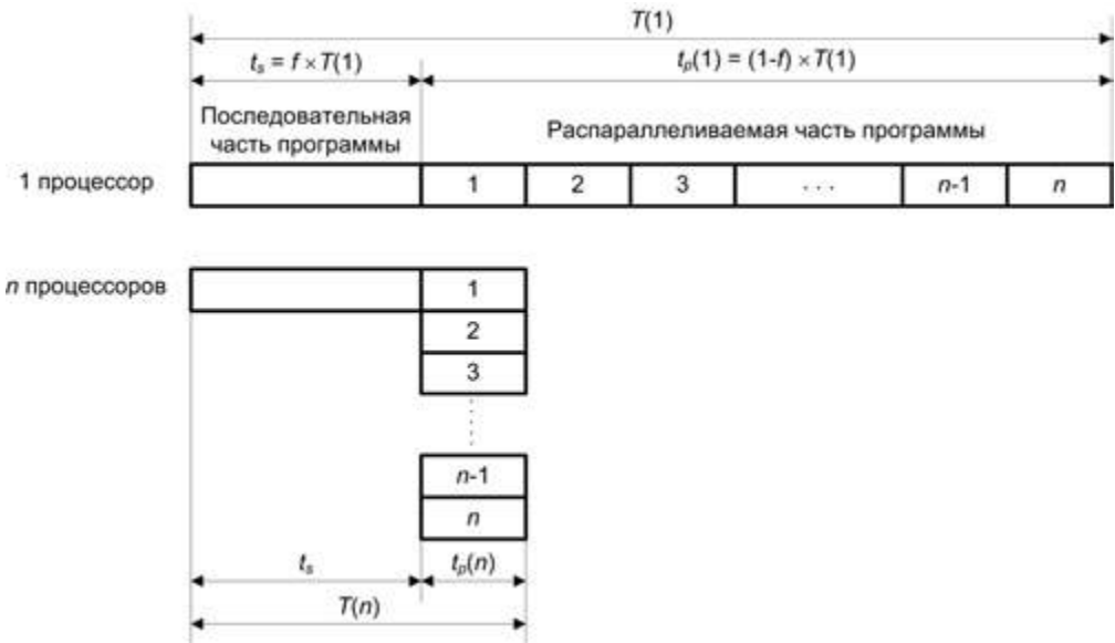
Рис. 10.3. Иллюстрация распараллеливания задачи в n -процессорной вычислительной системе
