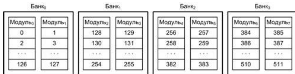
Рис. 6.5. Блочно-циклическая схема расслоения памяти
