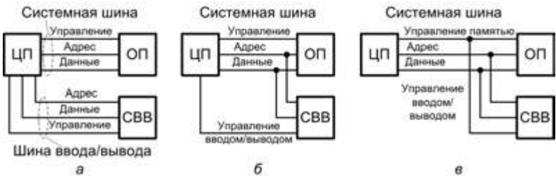
Рис. 8.1. Место системы ввода/вывода в архитектуре вычислительной машины: а — с отдельными шинами памяти и ввода/вывода; б — с совместно используемыми линиями данных и адреса; в — подключение на общих правах с процессором и памятью
