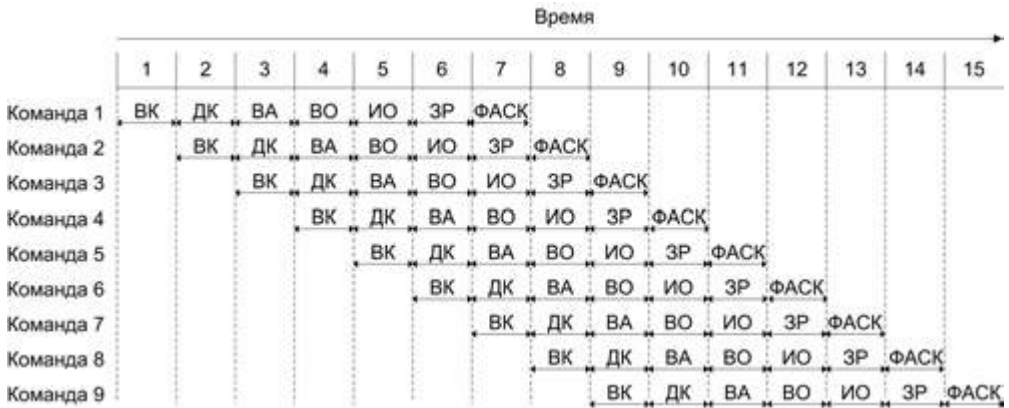
Рис. 9.3. Логика работы конвейера команд
