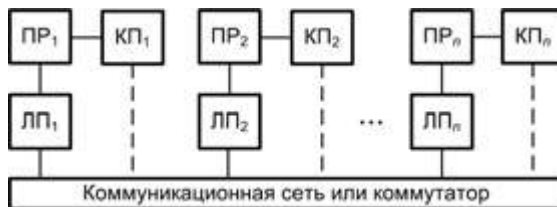
Рис. 11.5. Вычислительная система с неоднородным доступом к памяти (NUMA)
