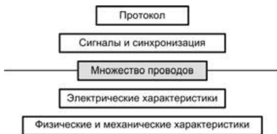
Рис. 7.2. Параметры, характеризующие шину
