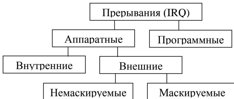
Рис. 2.30. Классификация типов прерываний
