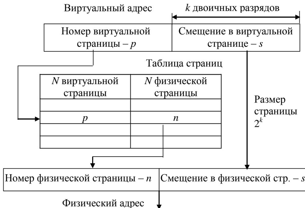
Рис. 4.16. Механизм преобразования виртуального адреса в физический при страничной организации памяти
