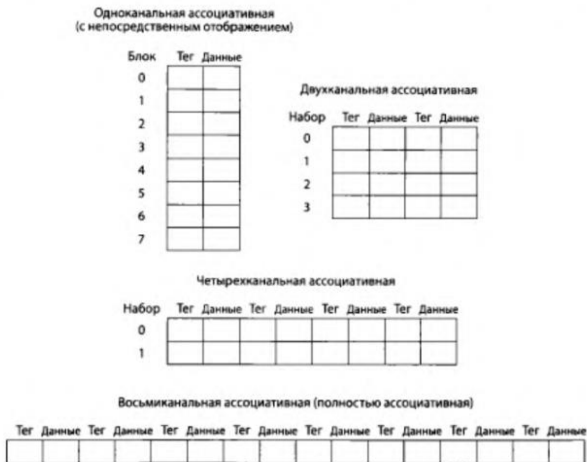
Рис. 3.9. Кэш-память из восьми блоков, сконфигурированная с непосредственным отображением, с двухканальной ассоциативностью, с четырехканальной ассоциативностью и в полностью ассоциативном варианте
