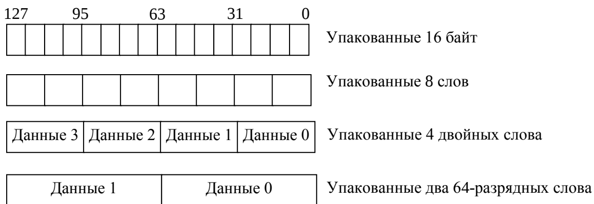
Рис. 2.5.9. Целочисленные данные SSE2 расширения
