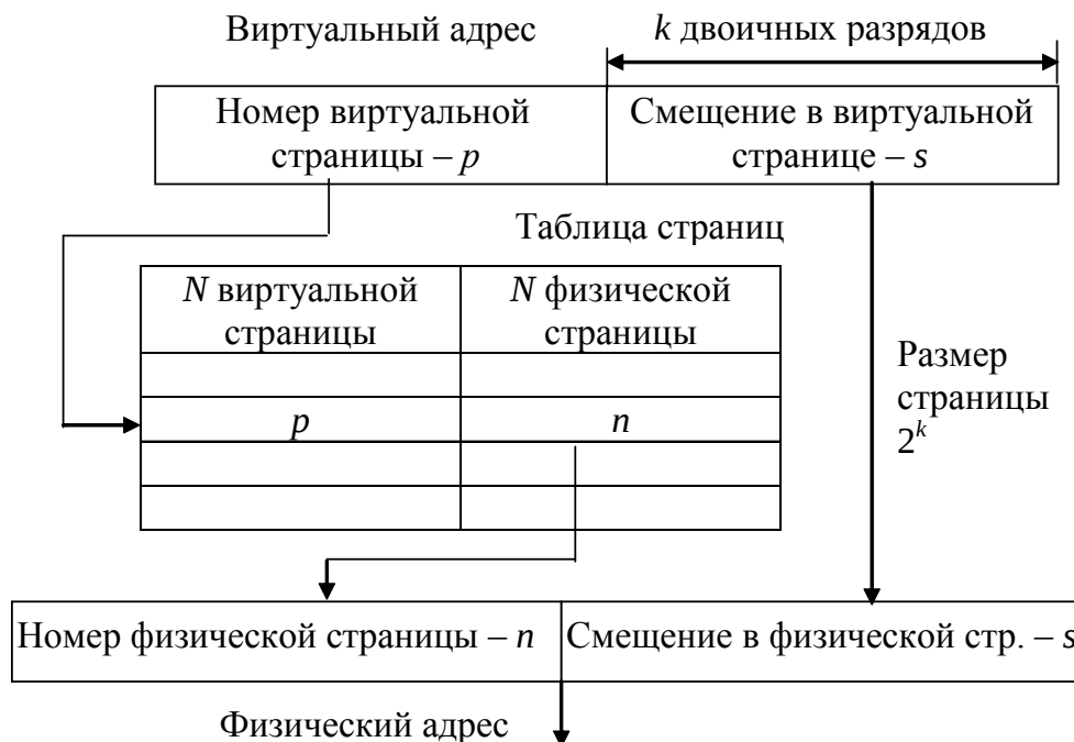
Рис. 3.19. Механизм преобразования виртуального адреса в физический при страничной организации памяти
