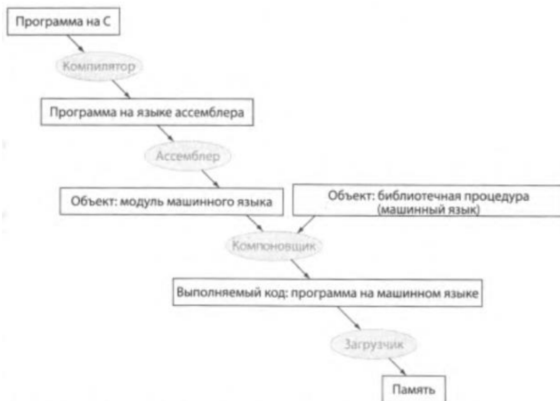
Рис. 1.2.5. Программа на C компилируется в программу на языке ассемблера, затем в машинный код
