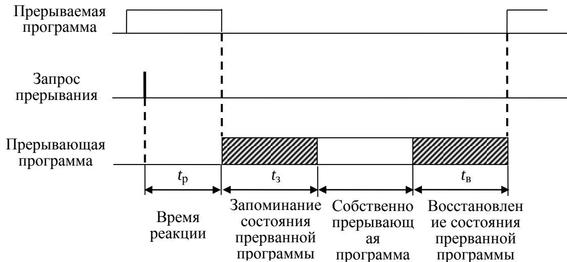
Рис. 2.10.1 Упрощенная временная диаграмма процесса прерывания
