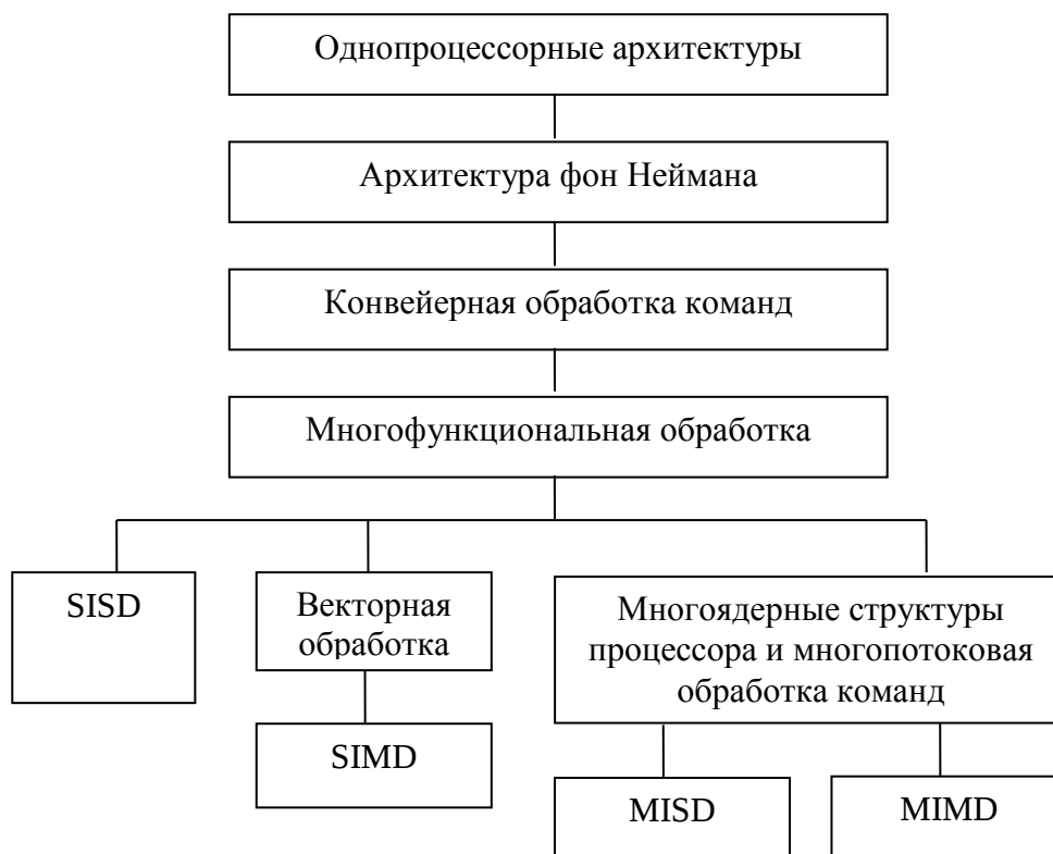
Рис. 2.3.1. Развитие и классификация однопроцессорных архитектур
