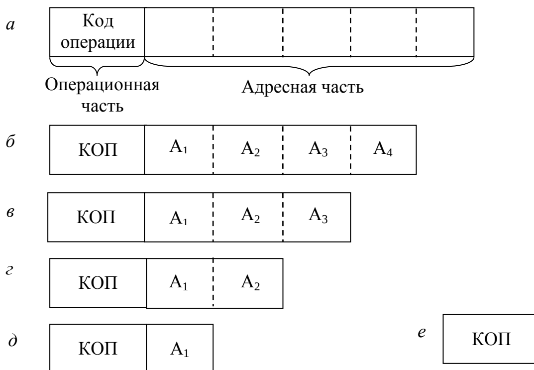
Рис. 2.6.1. Структуры команд: a – обобщенная; б – четырехадресная; в – трехадресная; г – двухадресная; д – одноадресная; е – безадресная
