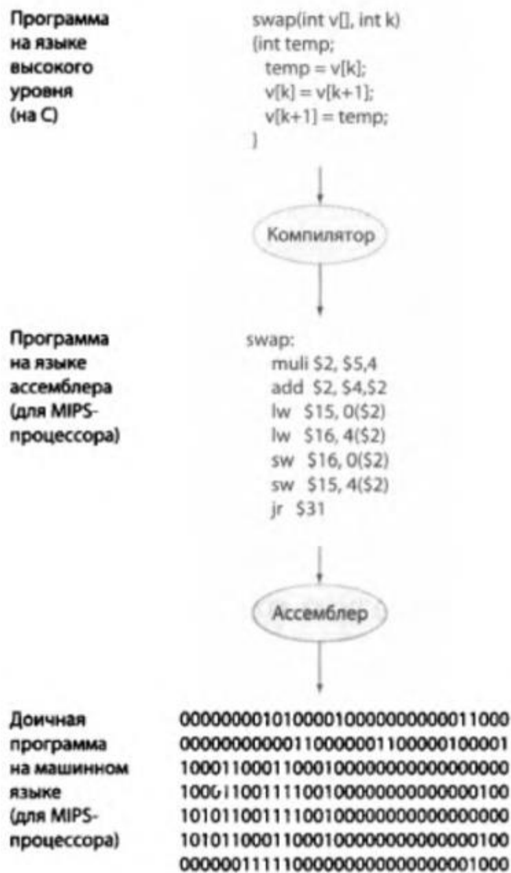
Рис. 1.2.4. Программа на C компилируется в программу на языке ассемблера, затем в машинный код
