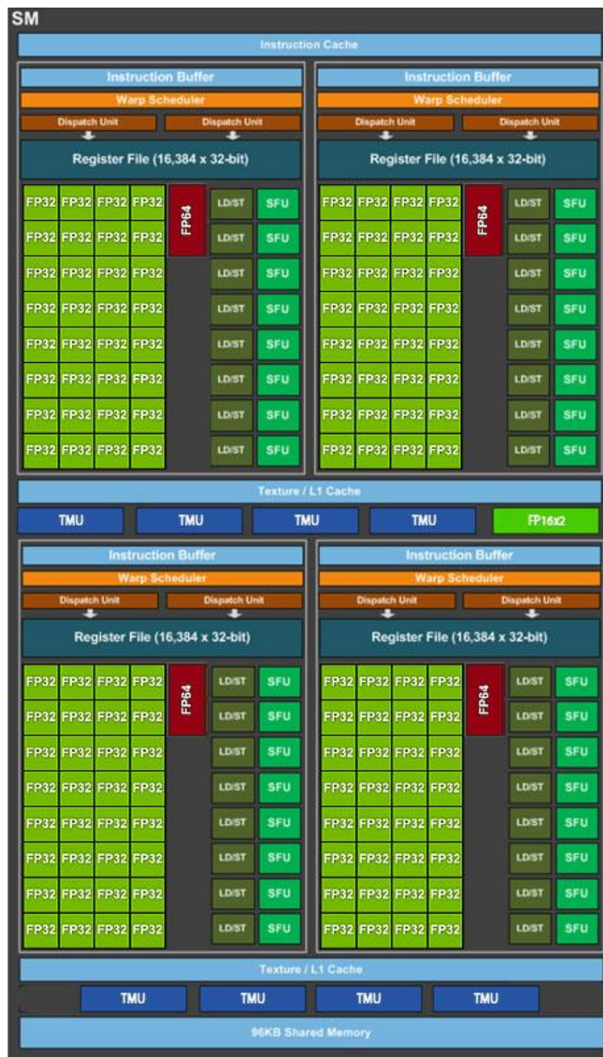
Рис. 5.1. Архитектура мультипроцессора NVIDIA Pascal
