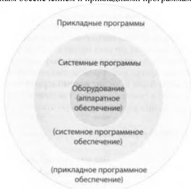
Рис. 1.2.3. Представление иерархических уровней аппаратного и программного обеспечения
