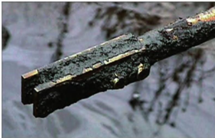
Рис. 1.3. Отложения парафинов на образцах контроля скорости коррозии весовым методом. Трубопровод \varnothing 426 \times 8 мм, длиной \sim 30 км транспортирует подготовленную ( H_2O < 1,0 % масс.) нефть на центральный пункт сбора (Западная Сибирь, Нижневартовский район)
