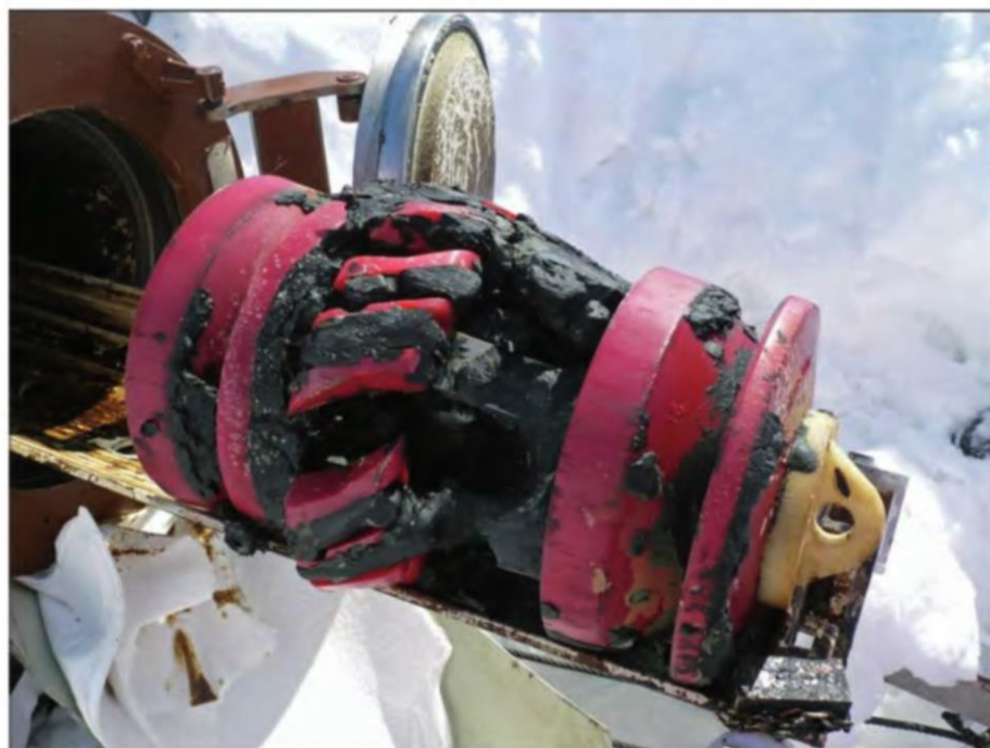
Рис. 1.15. Стержневой дисковый скребок со скребковыми манжетами из упругого материала и щетками
