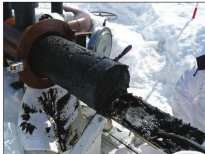
Рис. 1.4. Часть парафиновых отложений, вынесенных скребком в камеру приема из подводного трубопровода \varnothing 356 \times 14 мм, длиной \sim 73,5 км от нефтедобывающей платформы до береговой производственной площадки (северо-запад о. Сахалин, 2010 г.)
