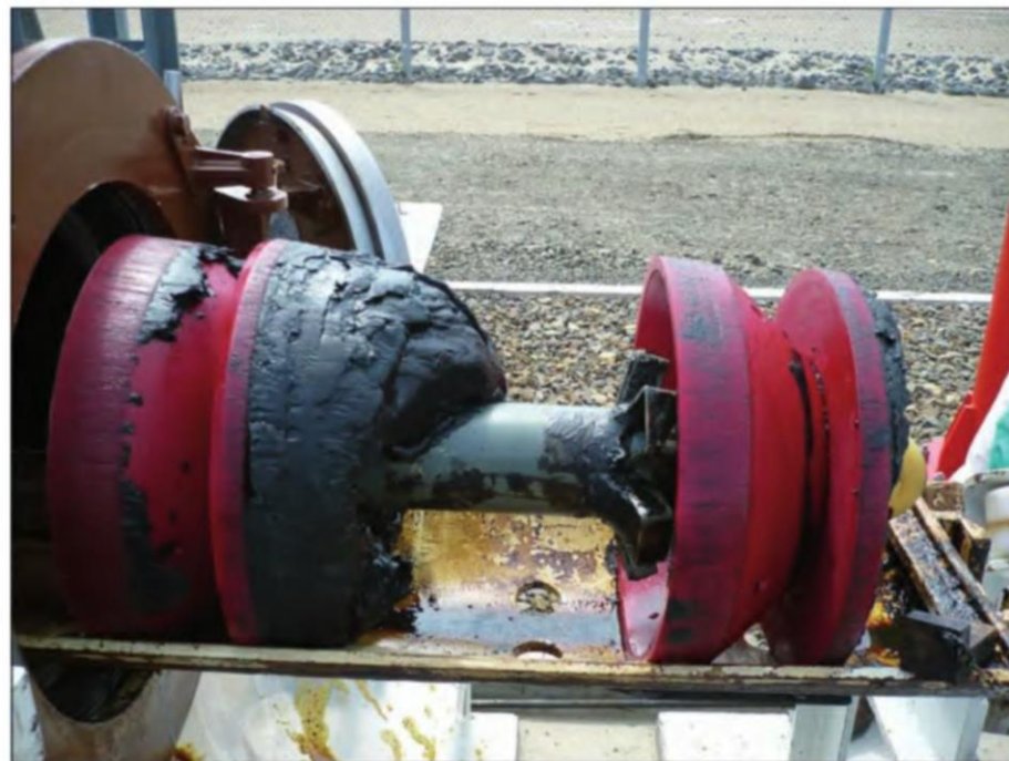
Рис. 1.13. Стержневой дисковый скребок со скребковыми манжетами из упругого материала
