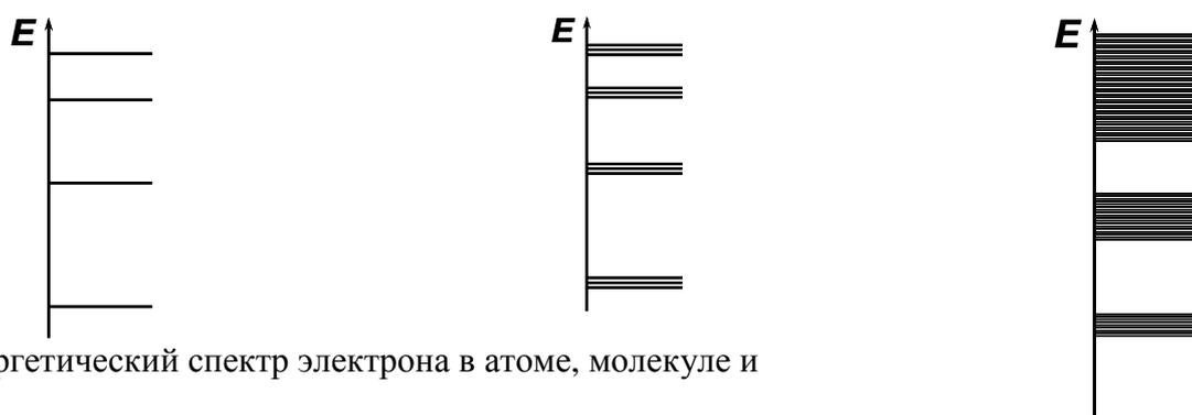
Рис. 2 Энергетический спектр электрона в атоме, молекуле и кристалле
