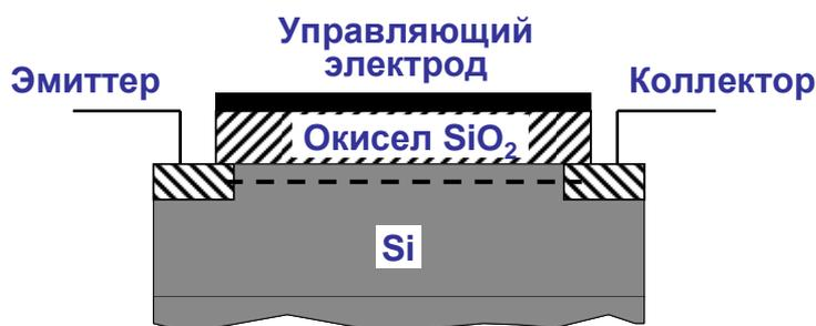
Рис. 5 Устройство МОП-транзистора
