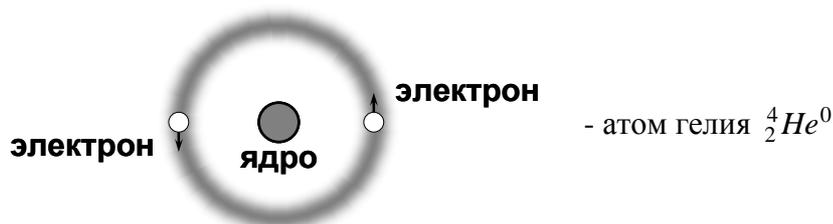
Верхний правый индекс дает суммарный заряд атома  $Q_a$ . Разность  $(Z - Q_a)$  – число электронов в атоме (ионе). Например,  ${}^4_2\text{He}^{1+}$  содержит  $2 - 1 = 1$  электрон, это однозарядный ион гелия. Ион кислорода  ${}^{16}_8\text{O}^{2-}$  содержит  $8 - (-2) = 10$  электронов.
