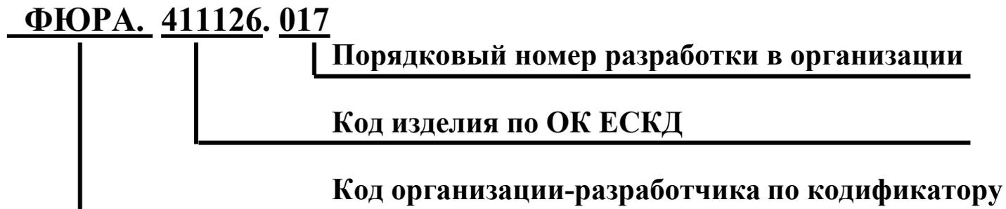
**Структура обозначения цифрового вольтметра постоянного и переменного тока, разработанного в ТПУ**
